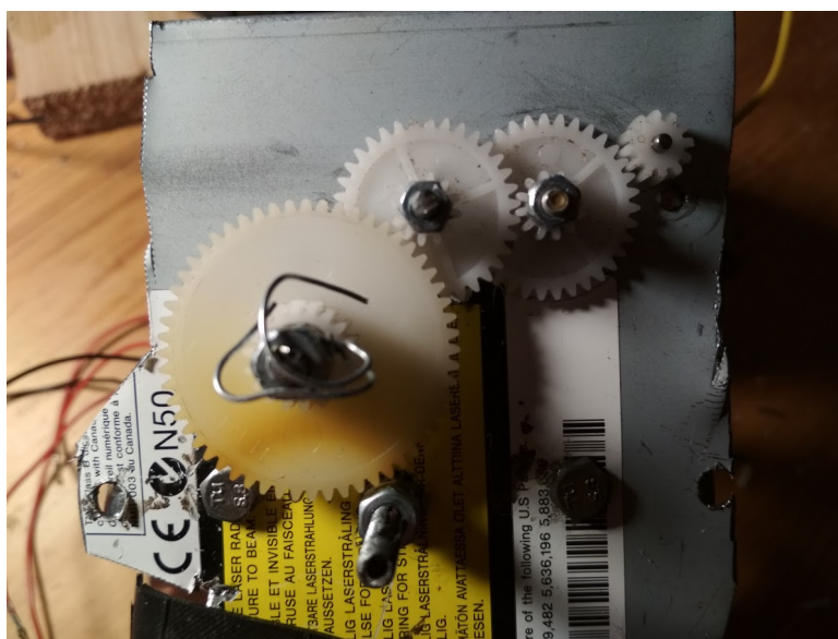
Obrázek C.3: Soustava převodových koleček pro otáčení paraboly
