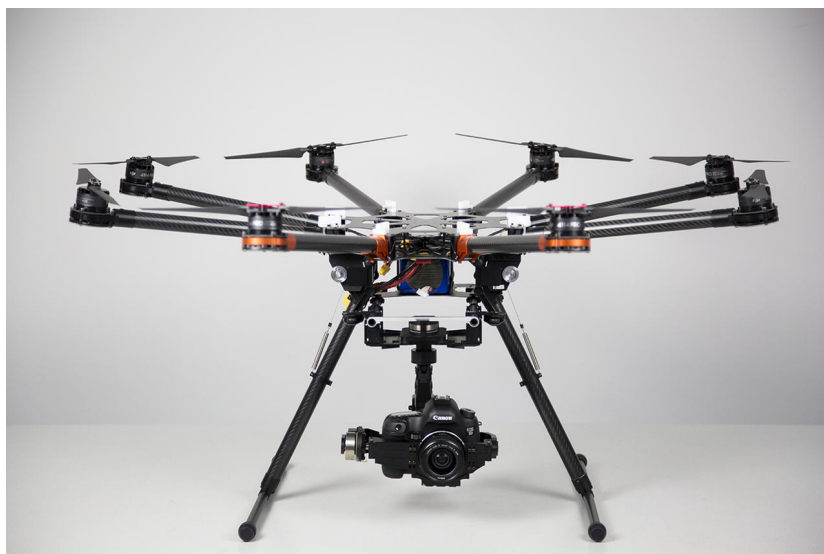
Obrázek 8 - Dron se vzletovou hmotností 8 kg [22]
