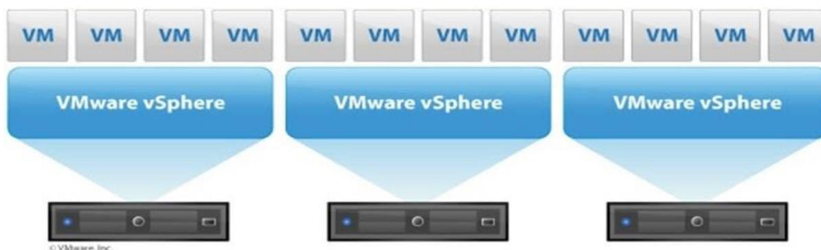
Obr. 42: Grafické zobrazení virtualizace (tři fyzické servery s dvanácti virtuálními stroji)
