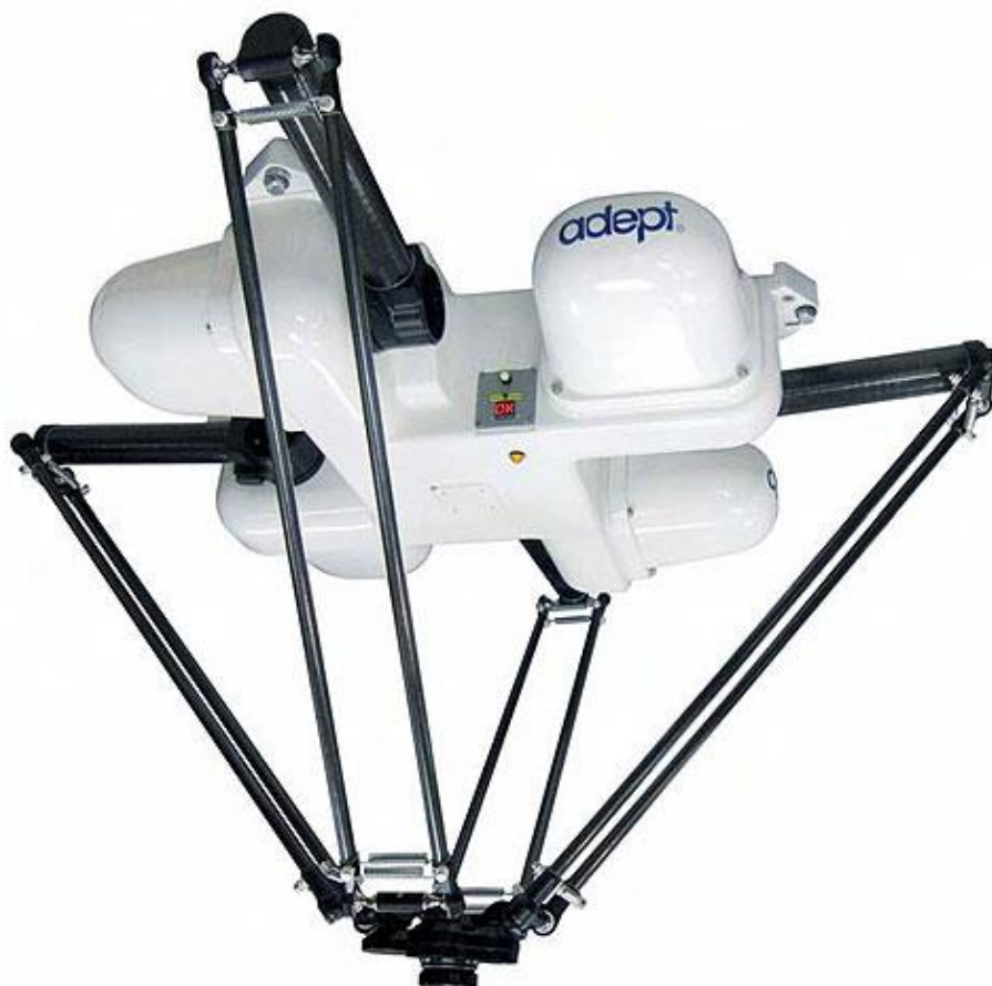
Obrázok 2.: Paralelný robot od firmy Adept s označením Quattro s650H
