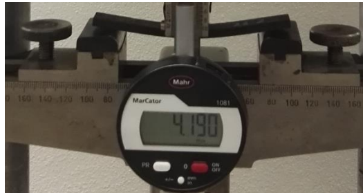
Obr. 26 - Maximálny priehyb pri sile 2,1 kN
