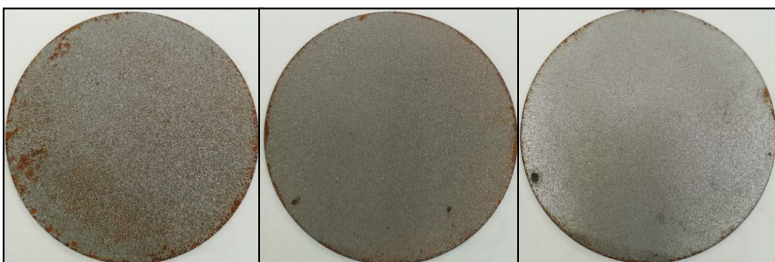
Obrázek 42. Vzorky po 9 hodinách v kondenzační komoře.
