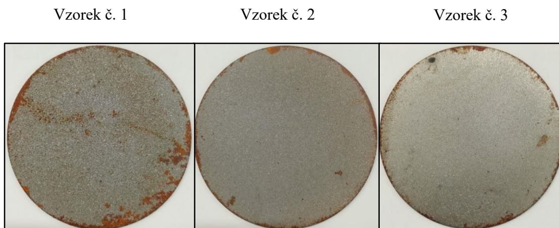
Obrázek 44. Vzorky po 18 hodinách v kondenzační komoře.
