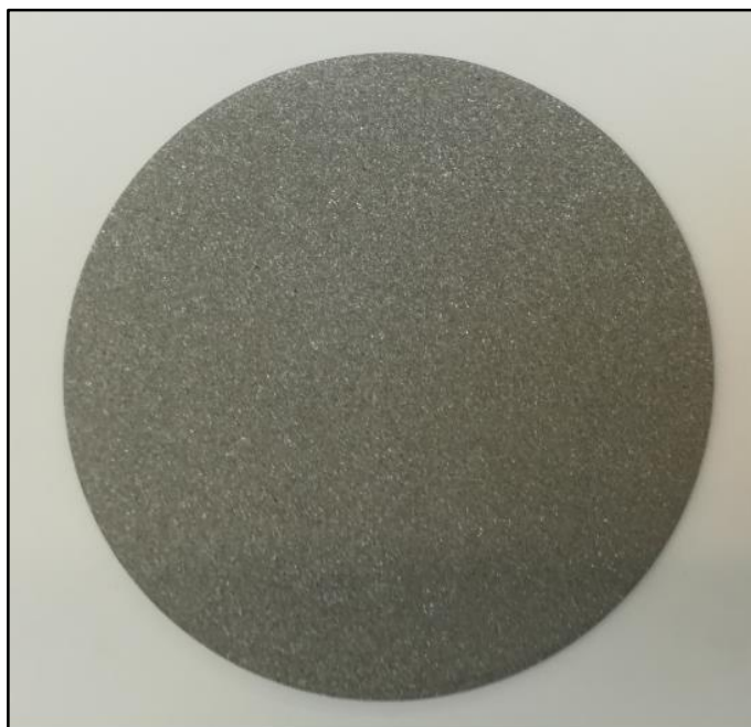
Obrázek 28. Vzorek č. 1 - tryskaný hnědým korundem
