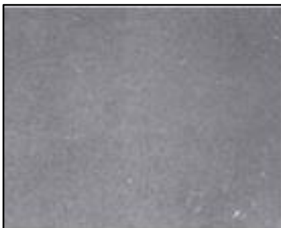
Obrázek 22. Stupeň čistoty Sa 3.
