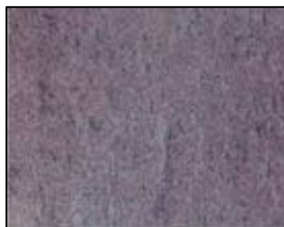
Obrázek 20. Stupeň čistoty Sa 2.
