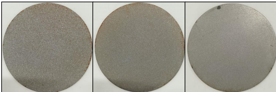
Obrázek 40. Vzorky po 3 hodinách v kondenzační komoře.
