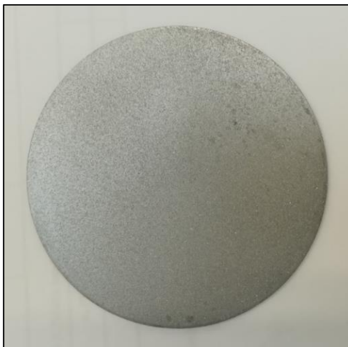
Obrázek 30. Vzorek č. 3 - tryskaný zinkovým drátem
