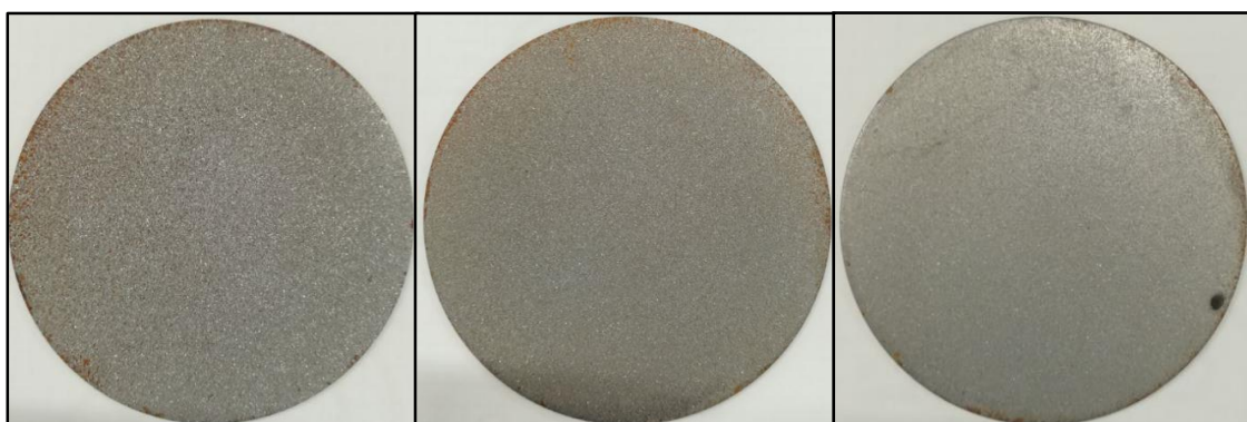
Obrázek 41. Vzorky po 6 hodinách v kondenzační komoře.
