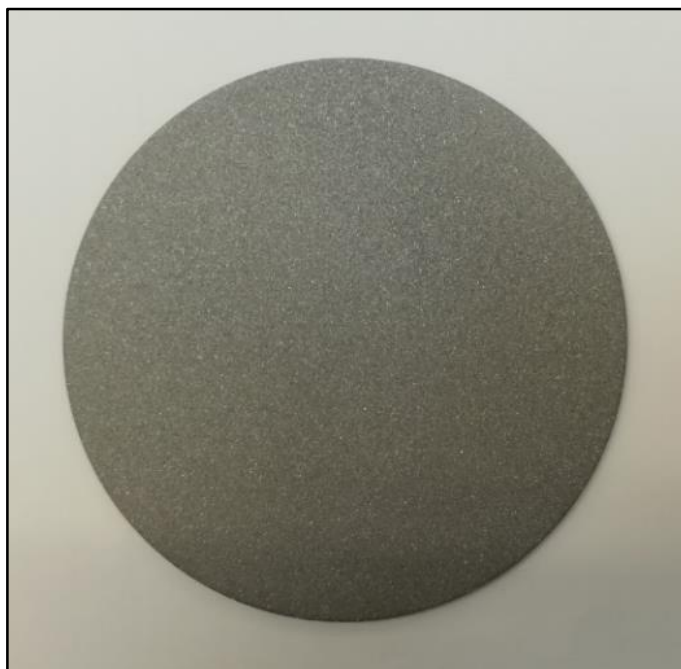
Obrázek 29. Vzorek č. 2 - tryskaný směsí korund/zinek
