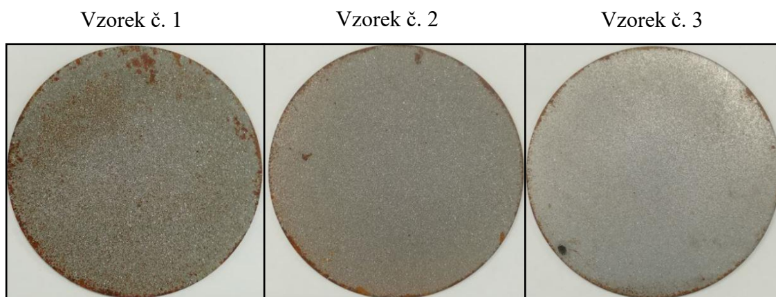
Obrázek 43. Vzorky po 12 hodinách v kondenzační komoře.
