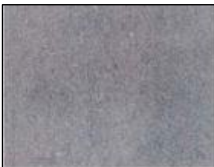
Obrázek 21. Stupeň čistoty Sa 2½.
