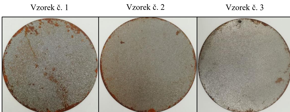
Obrázek 45. Vzorky po 24 hodinách v kondenzační komoře.
