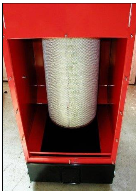
Obrázek 27. Pohled na filtr odlučovače. [34]
