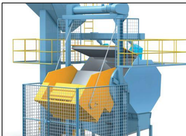
Obrázek 8. Bubnové tryskací zařízení s metacími koly. [30]
