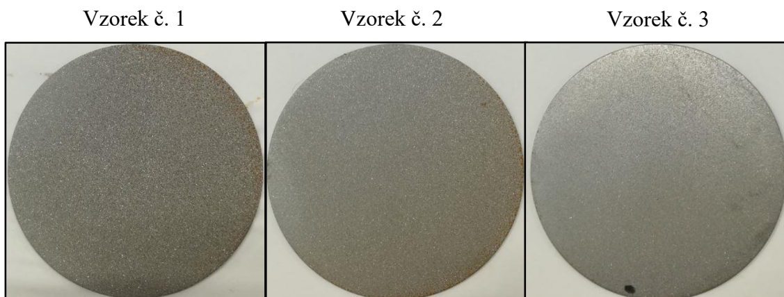
Obrázek 39. Vzorky po 1,5 hodině v kondenzační komoře.
