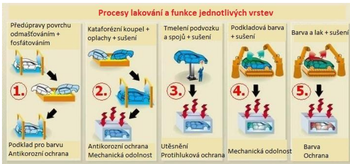
Obrázek 9 – Procesy lakování a funkce jednotlivých povlaků a vrstev [22]
