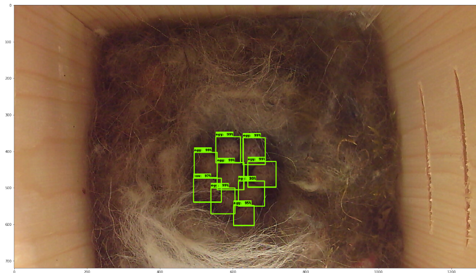
Obrázek 5.5: Model je schopný detekovat všech devět vajec i bez ohledu na to, že některá vejce jsou sotva viditelná.
