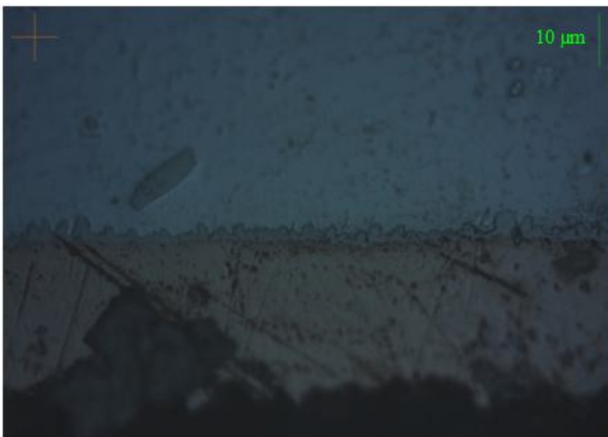
Obr. 31: Intermetalická vrstva při hf_2 = 707 sK (doporučený hf = 708,1 sK)
