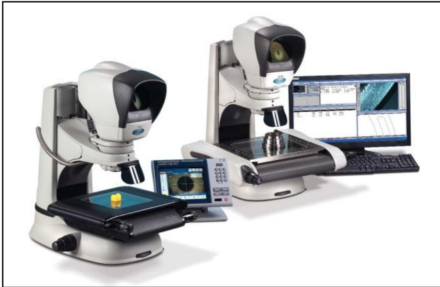
Obr. 21: Binokulární lupa Vision HAWK DUO QC-5000 [18]
