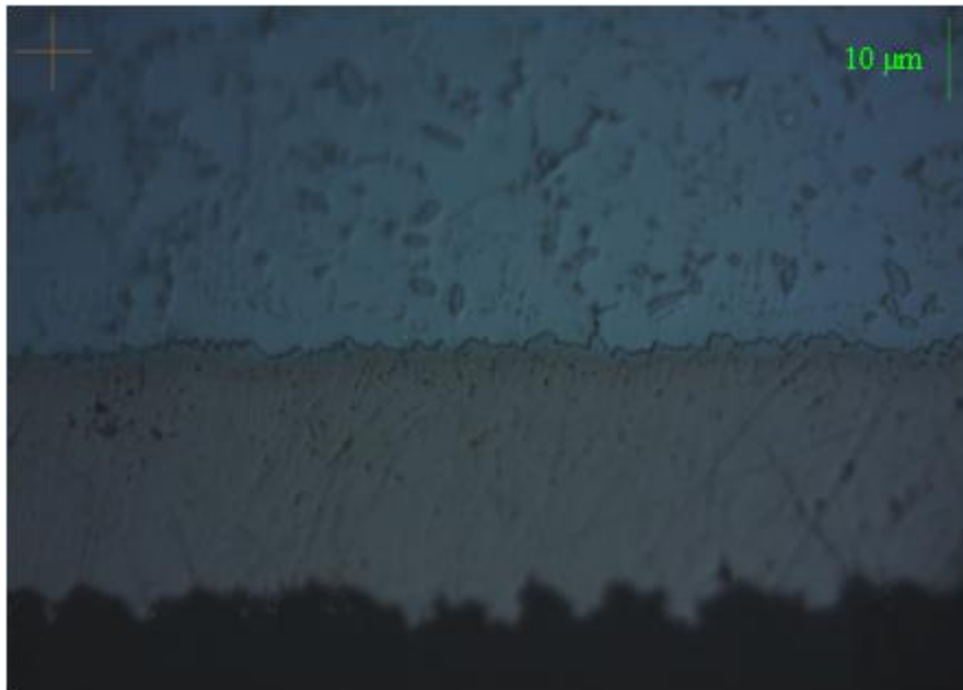
Obr. 30: Intermetalická vrstva při hf_1 = 231 sK (doporučený hf = 708,1 sK)
