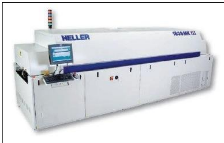
Obr. 3: Dusíková přetavovací pec [27]
