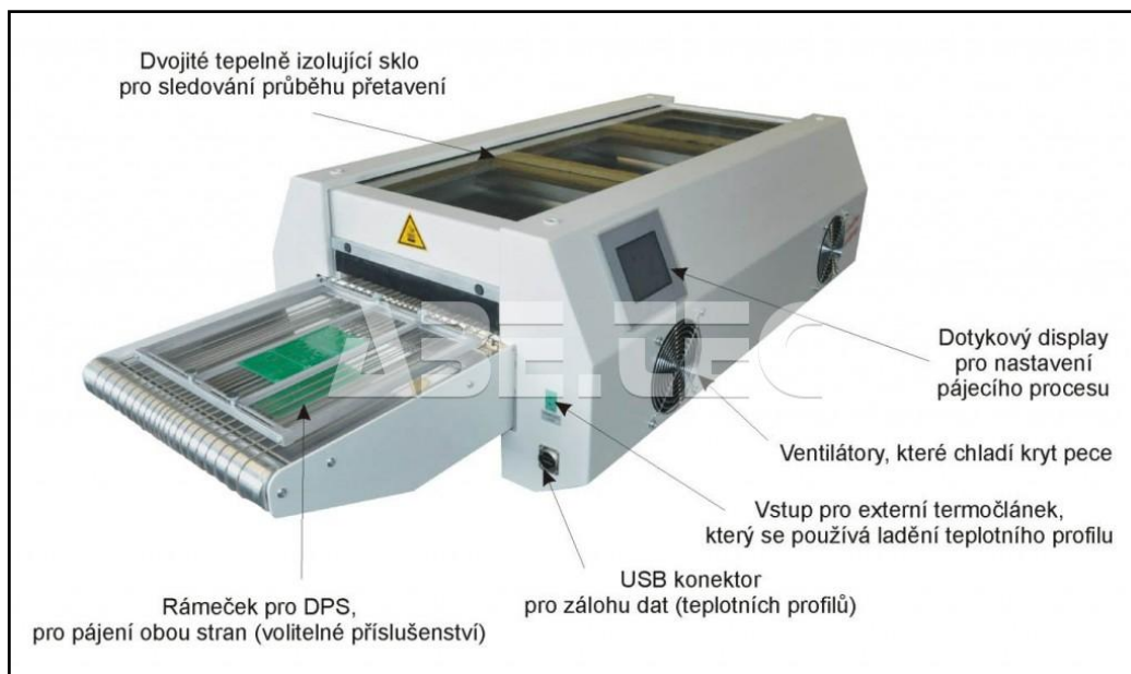
Obr. 19: Přetavovací tunelová pec Mistral 260 [17]
