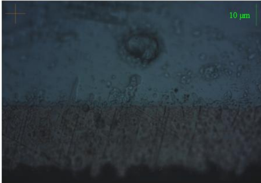
Obr. 32: Intermetalická vrstva při hf_3 = 1355 sK (doporučený hf = 708,1 sK)
