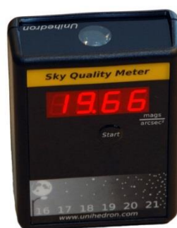
Obrázek 6.4 – SQM – L přístroj ( http://www.unihedron.com/projects/sqm-l/ )
