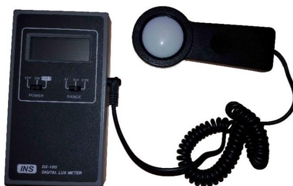
Obrázek 7.2 – Digitální luxmetr DX-100
