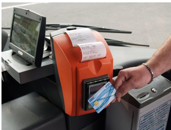
Obr. 11: Terminál vybavený tiskárnou v režimu odbavení cestujících předními dveřmi- Děčín (Zdroj: [32])
