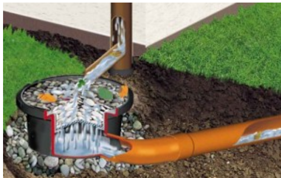
Obr. 35 Podokapový filtrační hrnec [65]
