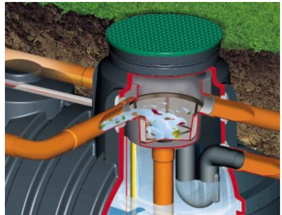
Obr. 38 Filtrační jednotka v akumulací nádrži [65]
