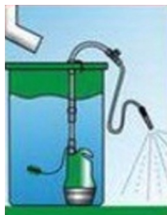
Obr. 51 Ponorné čerpadlo v sudu na dešťovou vodu [78]
