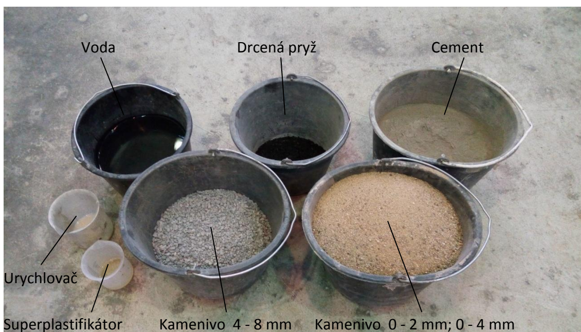
Obr. 7: Složky navrhované betonové směsi
