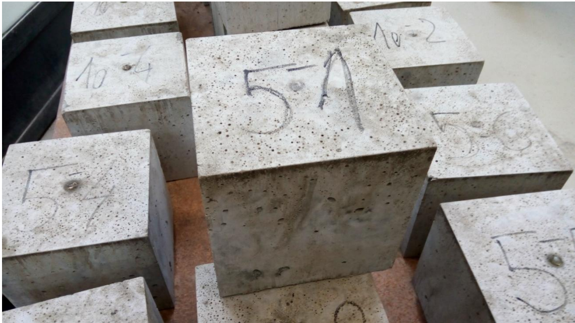
Obr. 9: Odbedněné betonové vzorky
