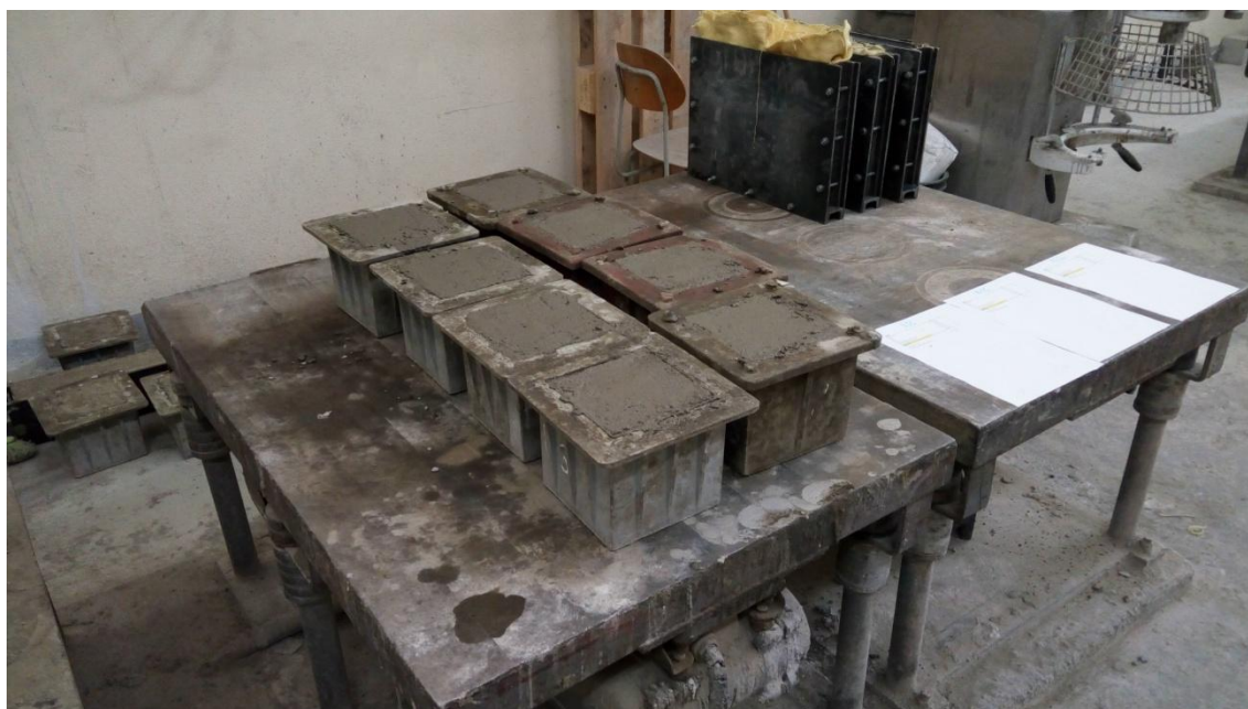
Obr. 8: Formy naplněné betonovou směsí
