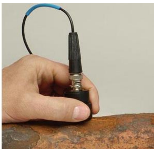
Obr. 30 Měření vnitřních korozních poškození potrubí pomocí ultrazvuku [23]
