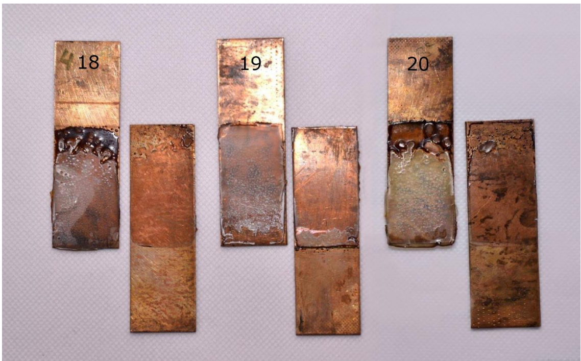
Obr. 34: Nebroušené měděné plechy + plazma PE
