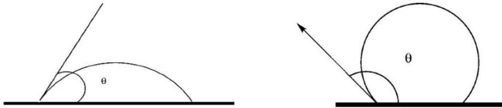
Obr. 5: Typ povrchu a) s dobrou smáčivostí b) se špatnou smáčivostí [8]
