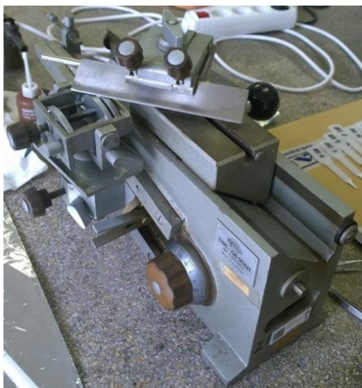
Obr. 25: Nůž na řezání tenkých fólií
