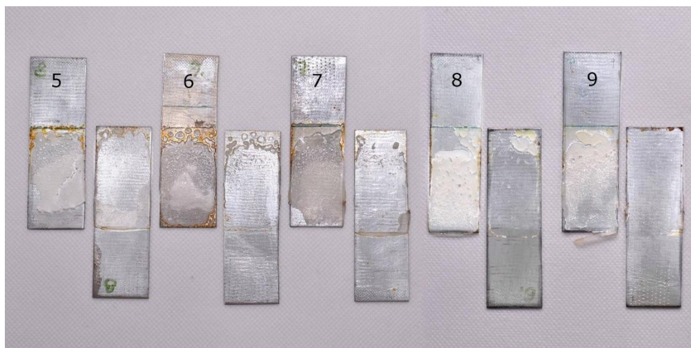
Obr. 31: Broušené pozinkované plechy + plazma PE
