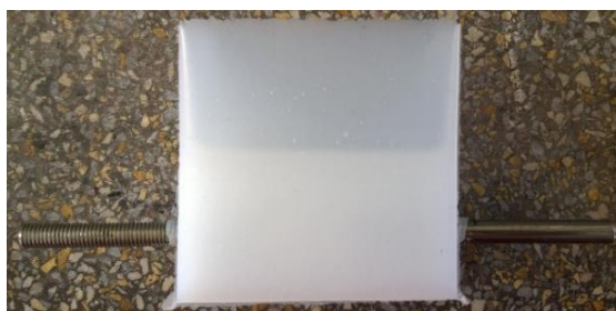
Obr. 15: Vzorek pro zkoušku tahem
