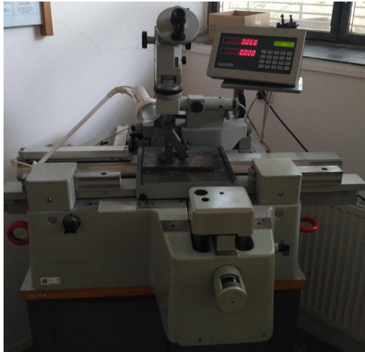
Obrázek 20 - Dílenský mikroskop s digitálním odměřováním
