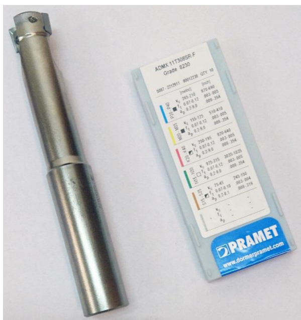
Obr.44: Zvolený nástroj a VBD
