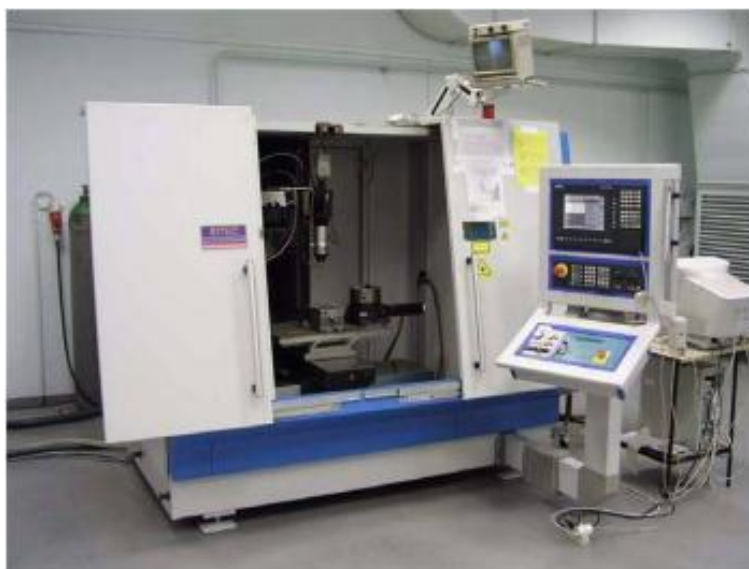
Obr. 10: 3-osý stroj od Firmy Sitec s laserem JK 701H Lumonics
