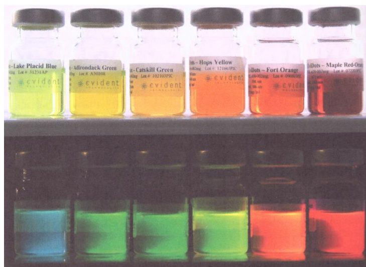
Obrázek 31 – Sada roztoků nanokrystalu CdSe v denním světle (nahore) a jejich fotoluminiscence buzená ultrafialovým zářením (dole)
