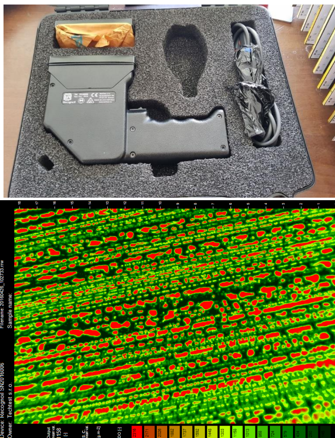
Obrázek 24 – Zařízení Recognoil a fluorescenční mapa
