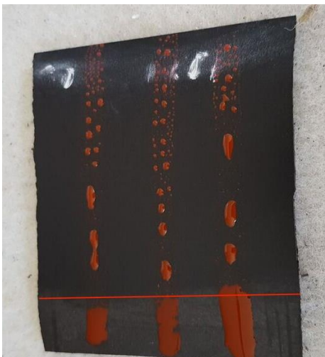
Obrázek 57 – Detekce nečistot inkoustem na Norylu
