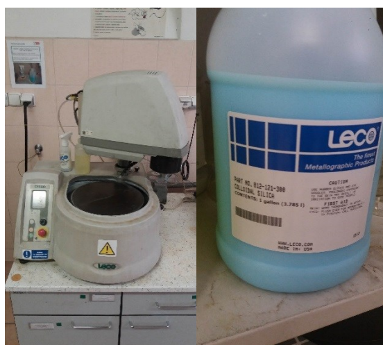
Obr. 19 Automatické bruska Leco GPX300 a nádoba s leštícím roztokem Leco Si (OH) 2 [fotografy autora BP]
