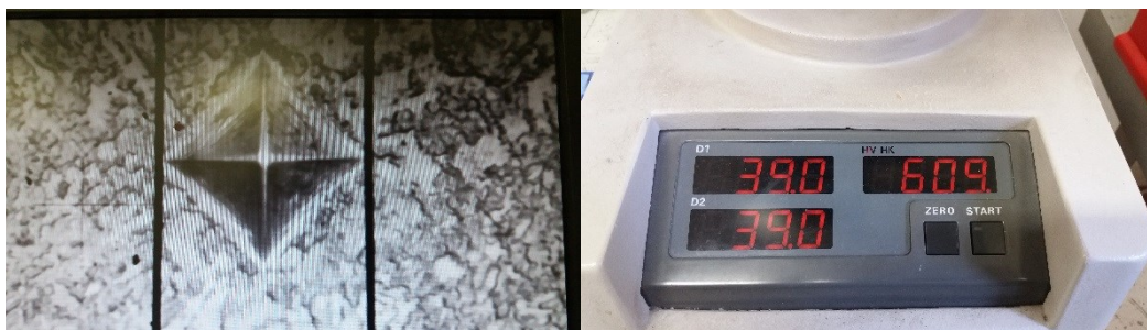
Obr. 22 Automatický výstup výsledné mikrotvrdomosti u zkoušky podle Vickerse [fotografická zpráva autora BP]
