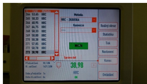
Obr. 21 Automatický výstup výsledné tvrdosti u zkoušky podle Rockwella [fotózáznam autora BP]
