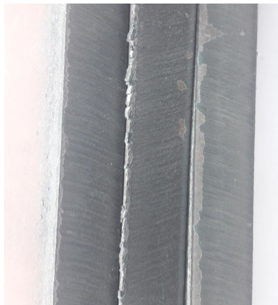
Obrázek 39 - Řezná hrana na vzorcích (r.40, r.55, r.70)
