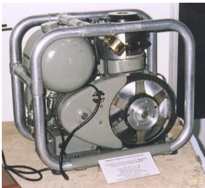
Obr. 2-2 Elektrocentrála firmy Philips využívající Stirlingův motor. [5]
