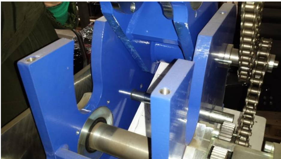
Obr. K7: Signovací stroj – vnitřek s převody
