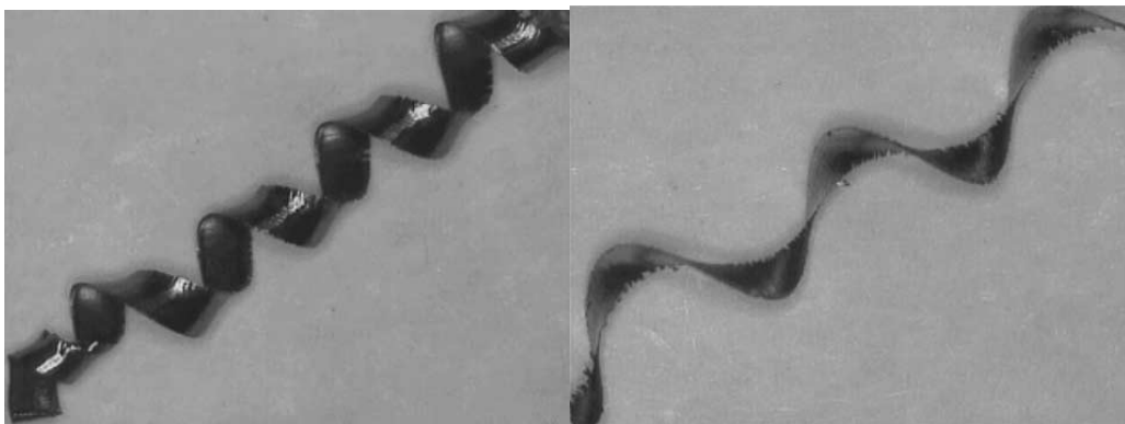
Obr. 3.1.4a Trieska vznikajúca pri suchom obrábaní a pri obrábaní s konvenčným chladením [15]
