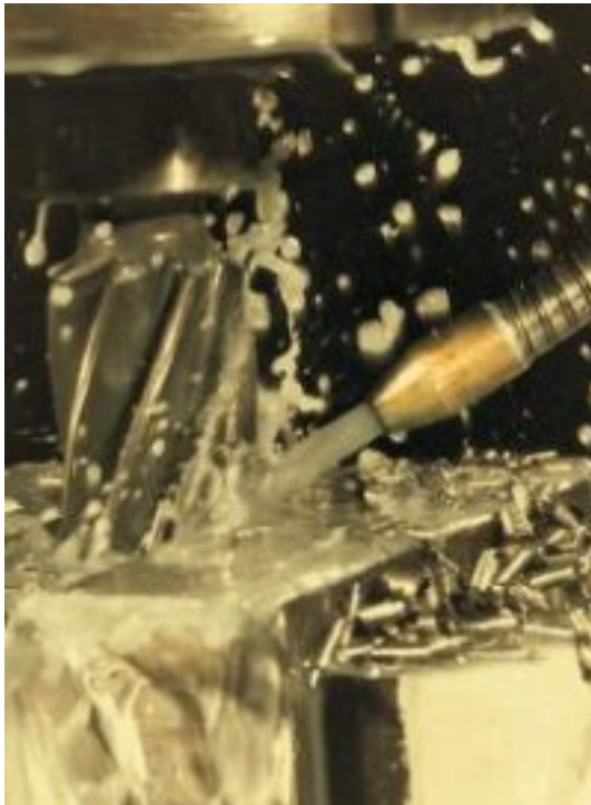
Obr. 1.2.1 Chladienie rezného procesu esterovým olejom [6]
