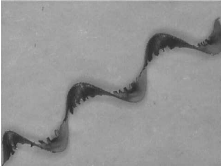
Obr. 3.1.4b Trieska vzniknutá pri obrábaní s vysokotlakovým chladením [15]
