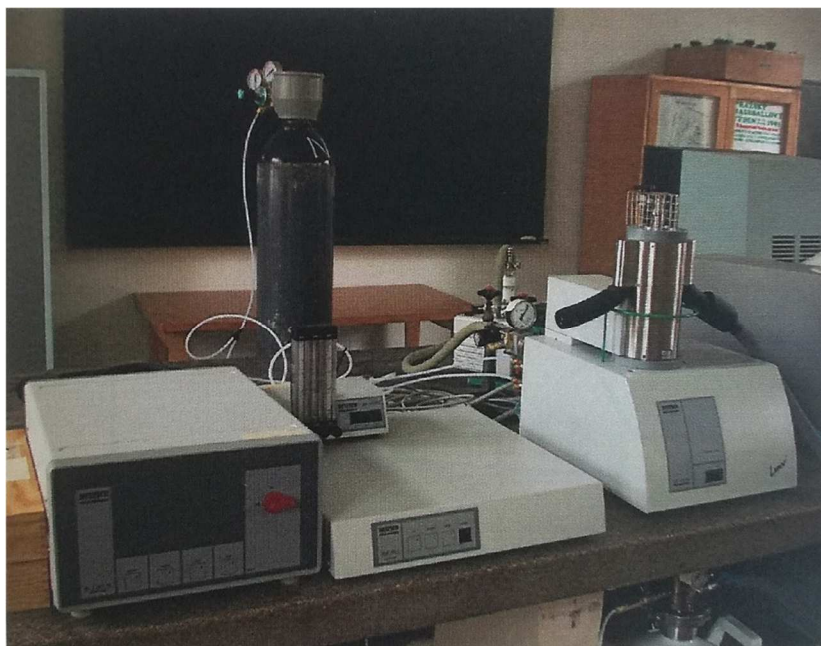
Obr. 15: Zařízení pro termickou analýzu NETZSCH STA 409PG LUXX [10]
