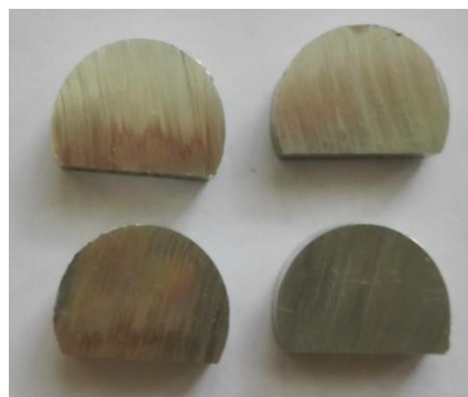
Obr. 78: Plochy z příčného řezu připravené k zalisování a následnému broušení a leštění
