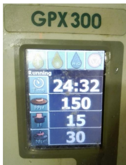
Obr. 20: vlevo: bruska/leštička LECO GPX 300, vpravo: displej brusky/leštičky s nastavenými podmínkami leštění
