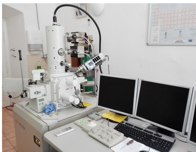
Obr. 23: Řádkovací elektronový mikroskop JEOL JSM-7600F
