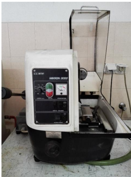
Obr. 19: Metalografická pila MTH MIKRON 3000
