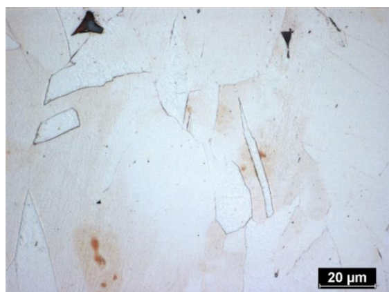
Obr. 33: Cu-ETP – podélný řez 2
