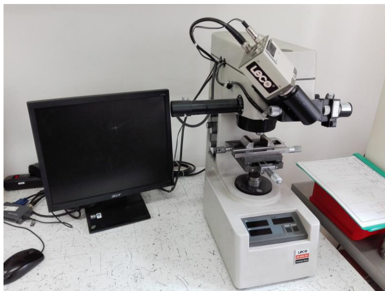
Obr. 26: Mikrotvrdoměr LECO M-400-G1
