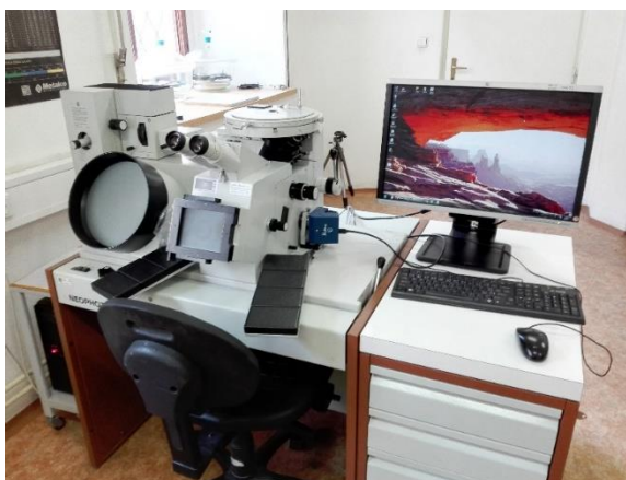
Obr. 21: Světelný metalografický mikroskop Zeiss Neophot 32
