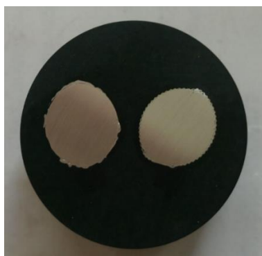
Obr. 75: Zalisované vzorky s řezem v podélném řezu
