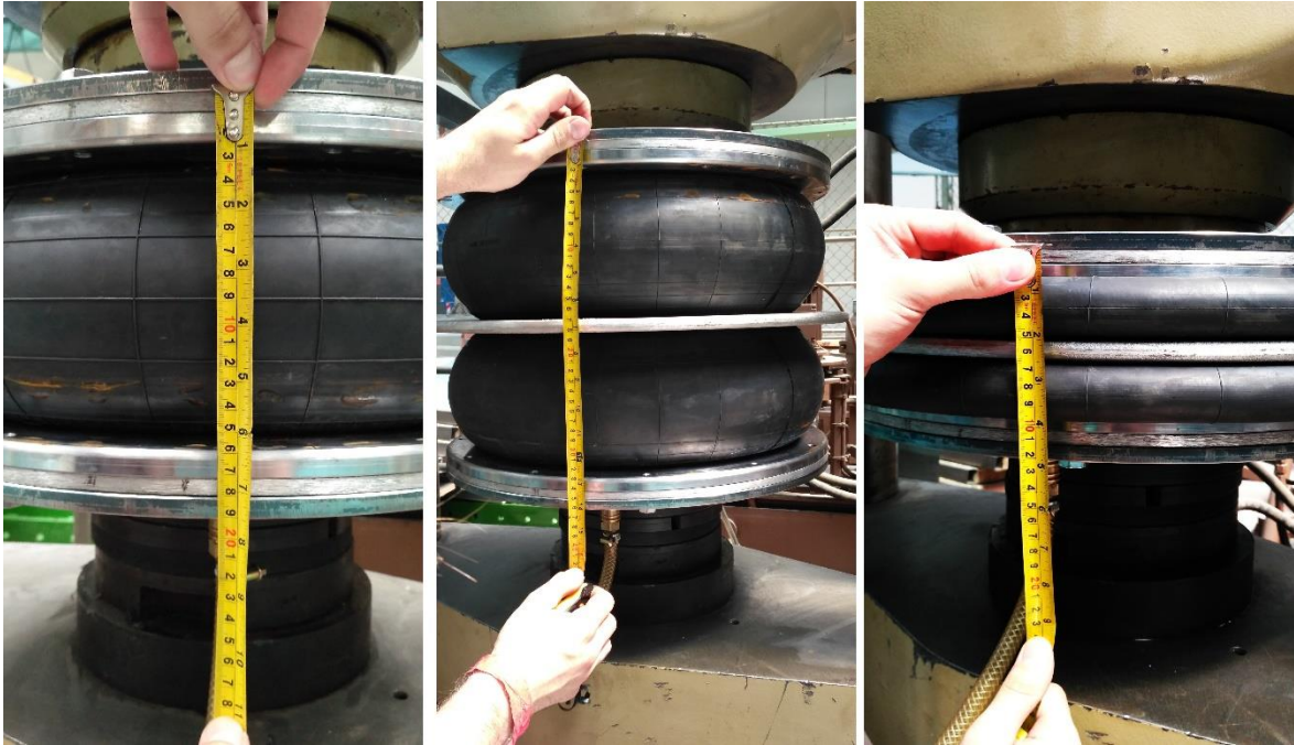
obr. 28: Kontrola velikostí jednotlivých zdvihů
