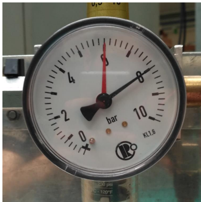
obr. 29: Dosažení maximálního pracovního přetlaku 8 bar
