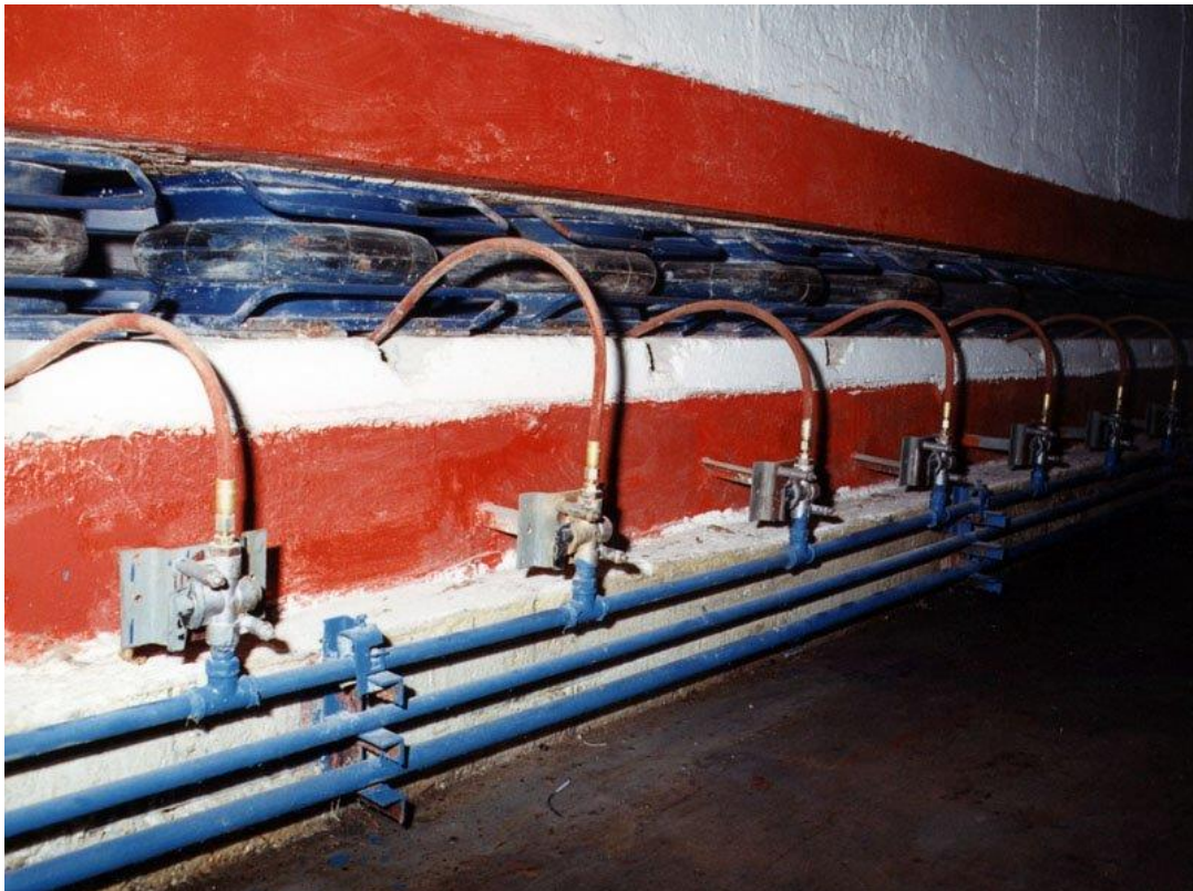
obr. 6: Uložení betonového lože na soustavě měchů [4]
