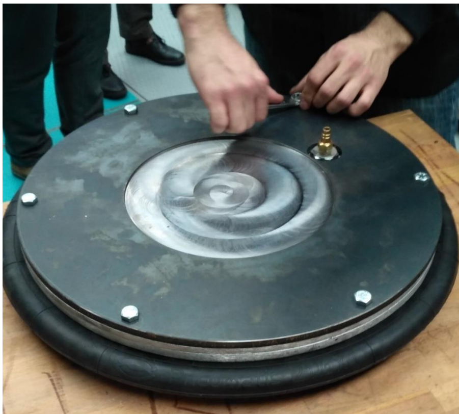
obr. 23: Přišroubování přípravku k vlnovci
