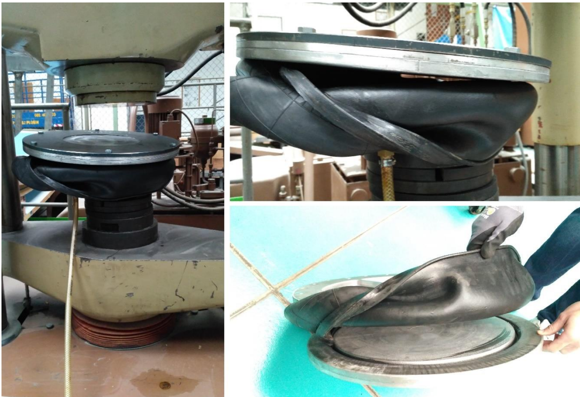
obr. 27: Vyklouznutí pryžového měchu z příruby
