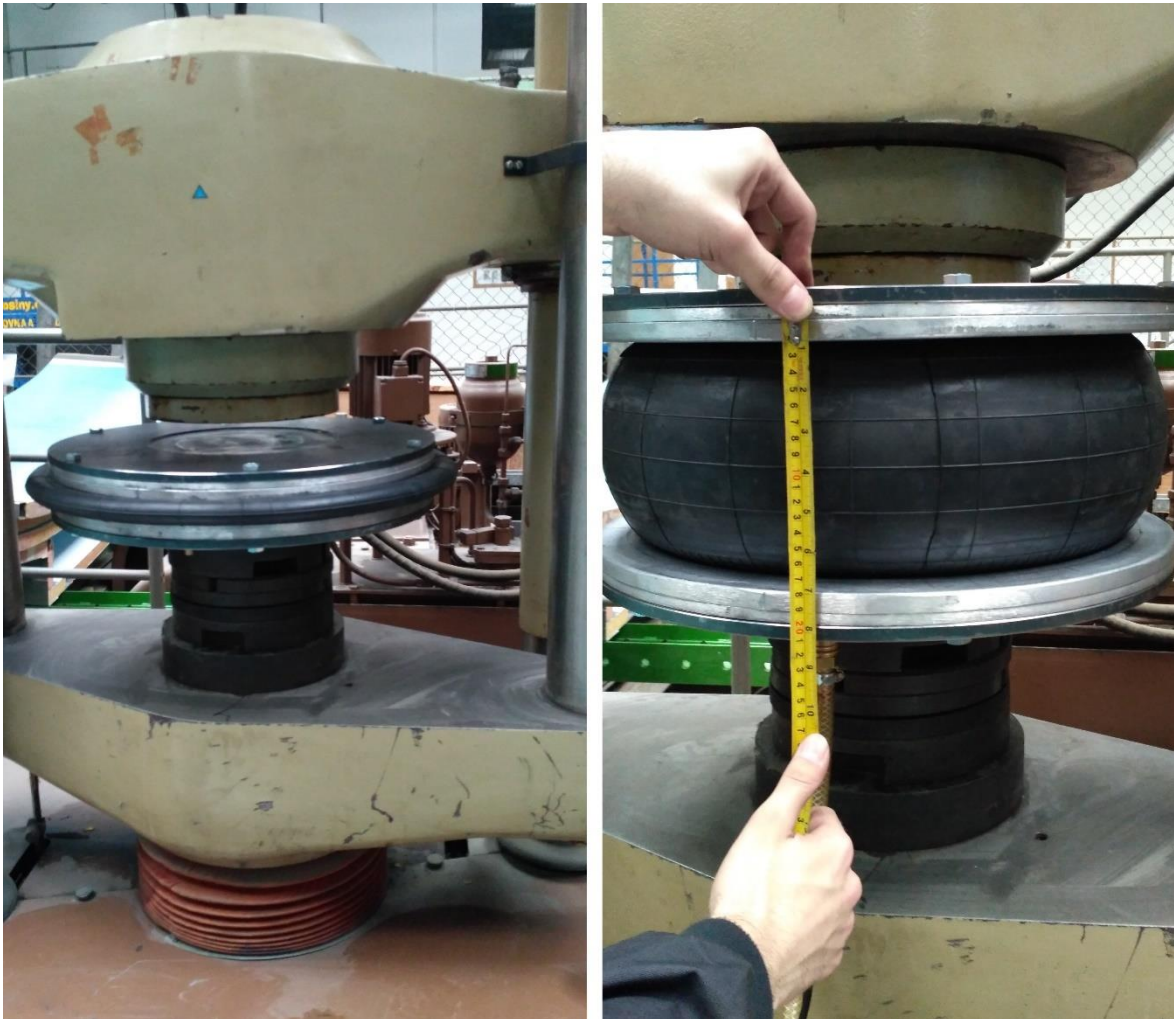
obr. 24: Vyfouknutý vlnovec (vlevo) a natlakovaný měch při ustavování polohy
