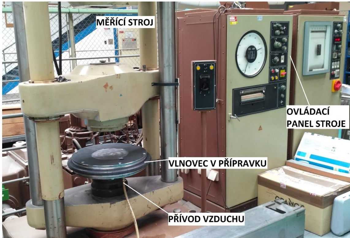
obr. 21: Detail měřícího stroje v laboratořích
