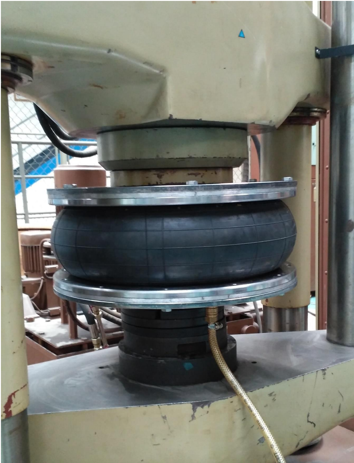
obr. 30: Ukázka velikosti natlakovaného vlnovce dimenze 21,5"x1
