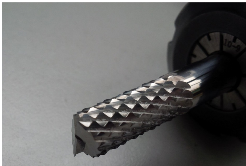
Obrázek 47 Válcová fréza Fraisa
