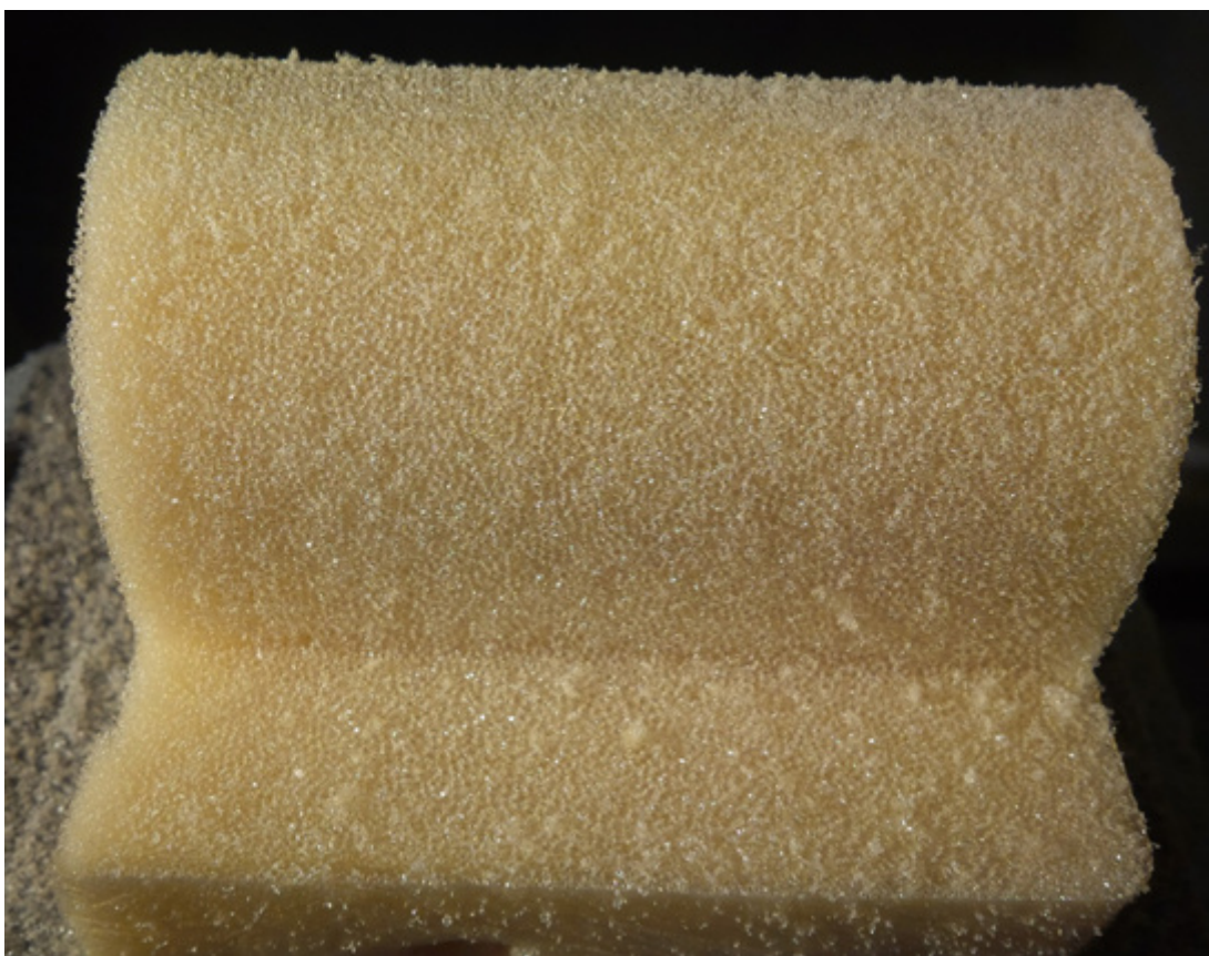
Obrázek 41 Povrch vzorku P21 s výraznou porézností
