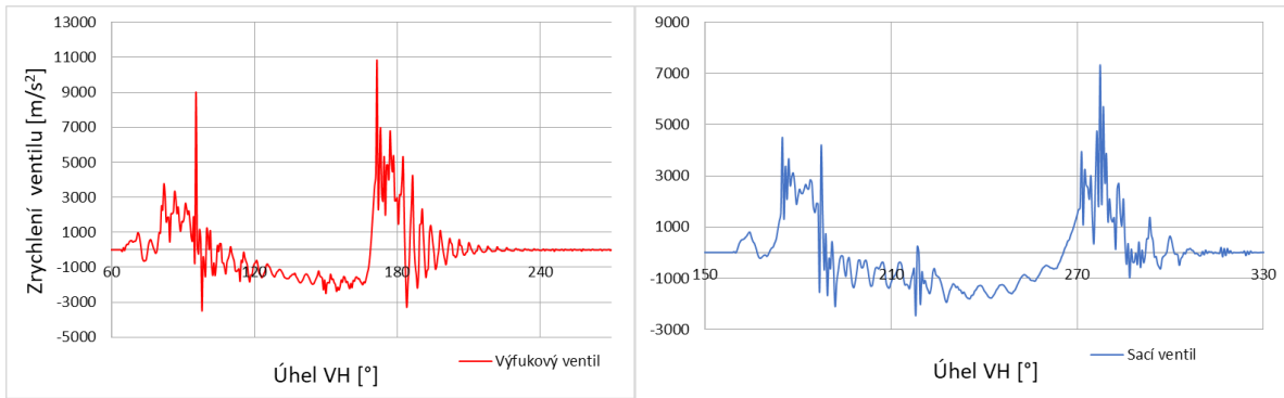
Obr. 9-35 - Predikce zrychlení sacího a výfukového ventilu pro 4000 1/min KH
