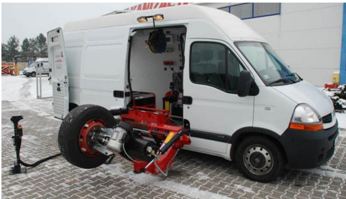
Obrázek 4: Mobilní servis nákladních automobilů v provozu
