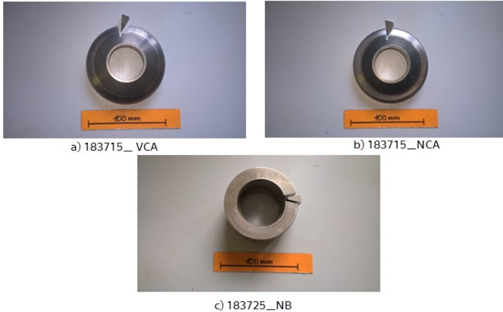
Obrázek 45 Vyříznuté vzorky pro zkoušku Pin On Disc: a) Vanadis 23 DCT, b) 1.2379 DCT, c) 1.2379 CHT
