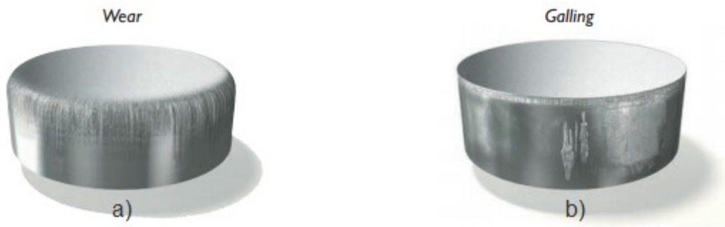
Obrázek 24 Druhy opotřebení: a) abraze (wear), b) adheze (galling) [31]
