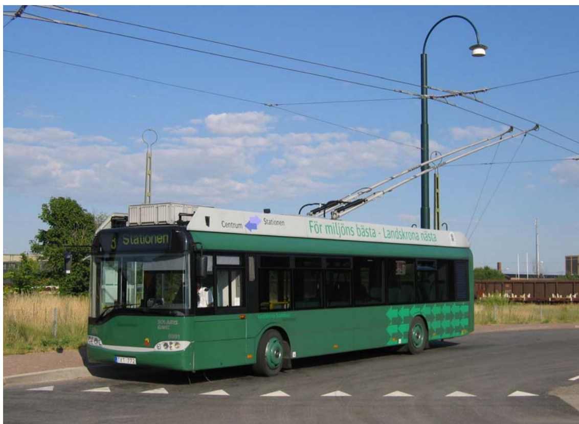
Obr. 12 – Trolejbus Solaris Trolino 12 ve švédském městě Landskrona [37]
