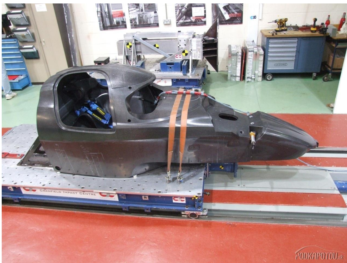
OBRÁZEK 2: KOMPOZITOVÝ MONOKOK PRAGY R1 NA CRASHTESTECH [9]
