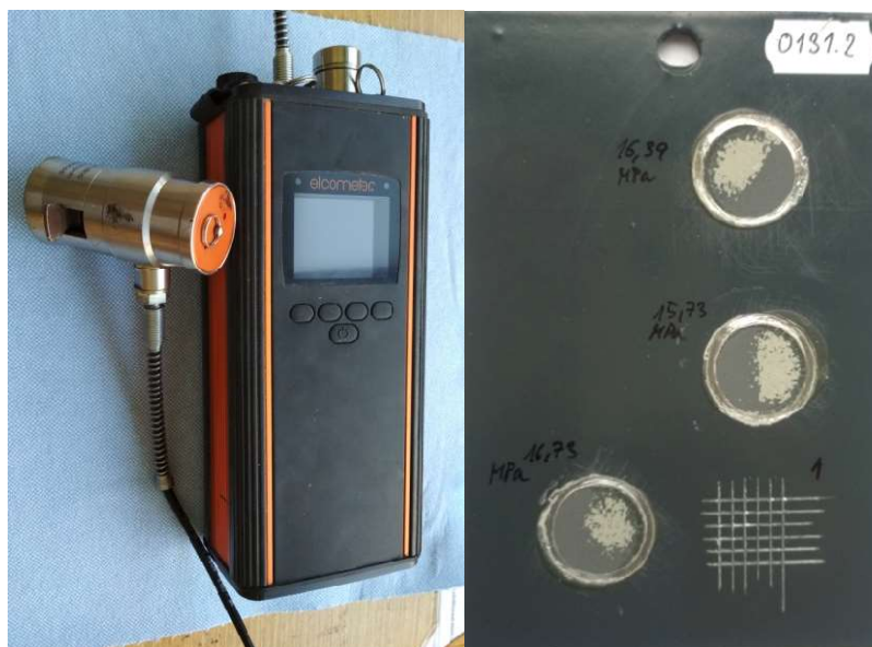
Obrázek 14 - Odtrhové zařízení Elcometer použité v experimentální části vlevo, vpravo ukázka hodnocení přilnavosti na vzorku č. 0131.2
