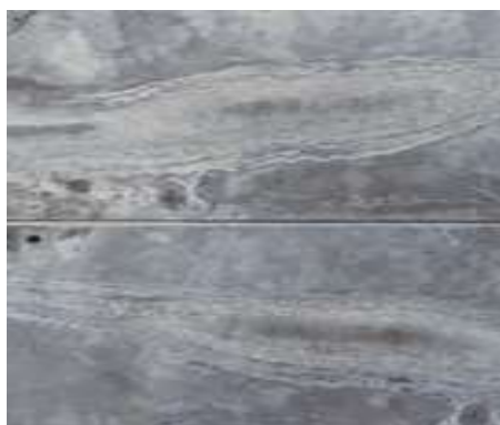
Obrázek 3 - Vzhled bílé rzi (hydroxidu zinečnatého) na povrchu zinku [22]
