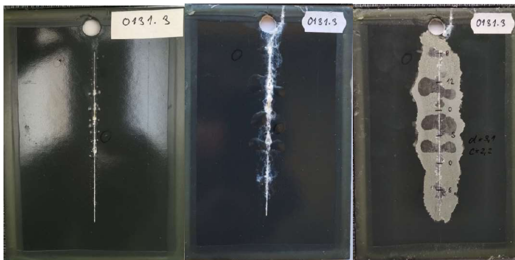
Obrázek 16 - Vzorek 0131.3 vlevo, expozice 480 hod., vzorek 0131.3 uprostřed, expozice 1700 hod., vzorek 0131.3 vpravo po odstranění nátěru a vyhodnocení delaminace, podkorodování
