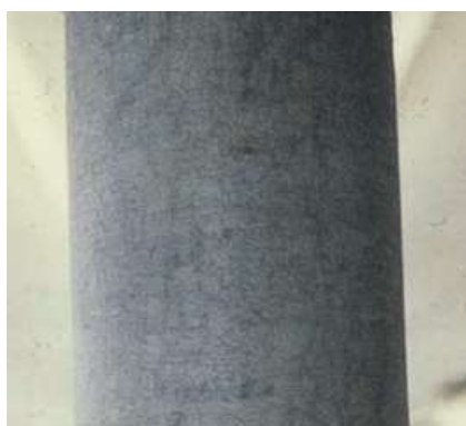
Obrázek 4 - Vzhled patinového efektu na povrchu zinku [22]
