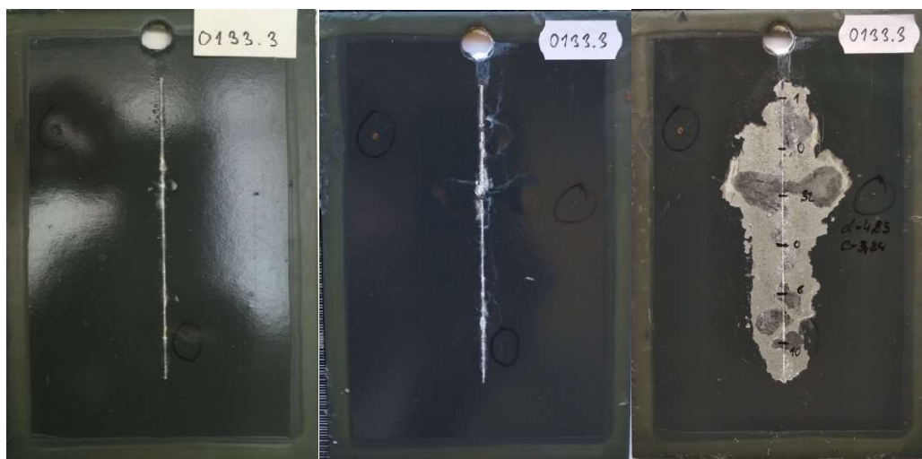
Obrázek 17 - Vzorek 0133.3 vlevo, expozice 480 hod., vzorek 0133.3 uprostřed, expozice 1700 hod., vzorek 0133.3 vpravo po odstranění nátěru a vyhodnocení delaminace, podkorodování
