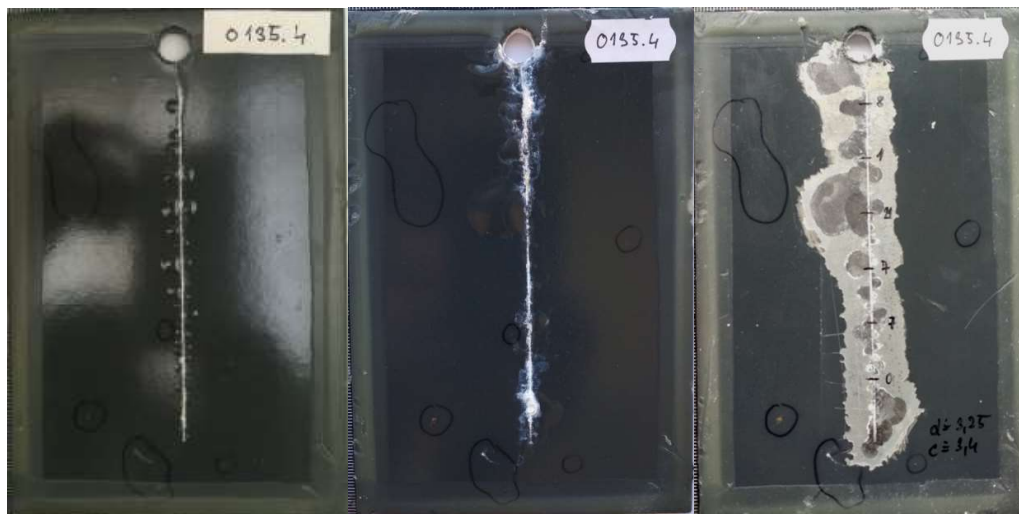
Obrázek 18 - Vzorek 0135.4 vlevo, expozice 480 hod., vzorek 0135.4 uprostřed, expozice 1700 hod., vzorek 0135.4 vpravo po odstranění nátěru a vyhodnocení delaminace, podkorodování
