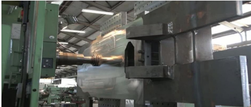
Obr. 8.9 Opracování segmentu rámu [19]
