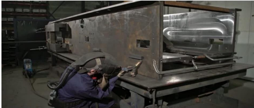
Obr. 8.11 Postup svařování rámu [19]
