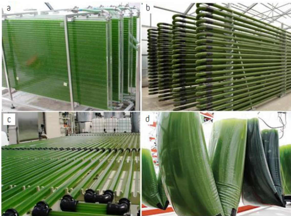
Obrázek 2. Fotobioreaktory a, Panelový fotobioreaktor; b, Vertikální tubulární fotobioreaktor; c, Horizontální tubulární fotobioreaktor; d, Plastové pytle [9]
