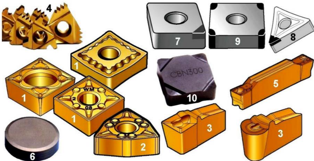
Obr. 8: 1 - SK, tvar S, oboustranné, předlisovaný utvařeč; 2 - SK, tvar W, oboustranná, předlisovaný utvařeč; 3 - SK, zapichovací, předlisovaný utvařeč; 4 - SK, závitové; 5 - SK, upichovací, předlisovaný utvařeč; 6 - monolitní PKNB, tvar R; 7 - roubík PD, tvar C, jednostranná; 8 - roubík PD, tvar T, jednostranná, utvařeč; 9 - roubíky PD, tvar S, oboustranná; 10 - monolitní PKNB, tvar S, jednostranná, vybroušený utvařeč [34]
