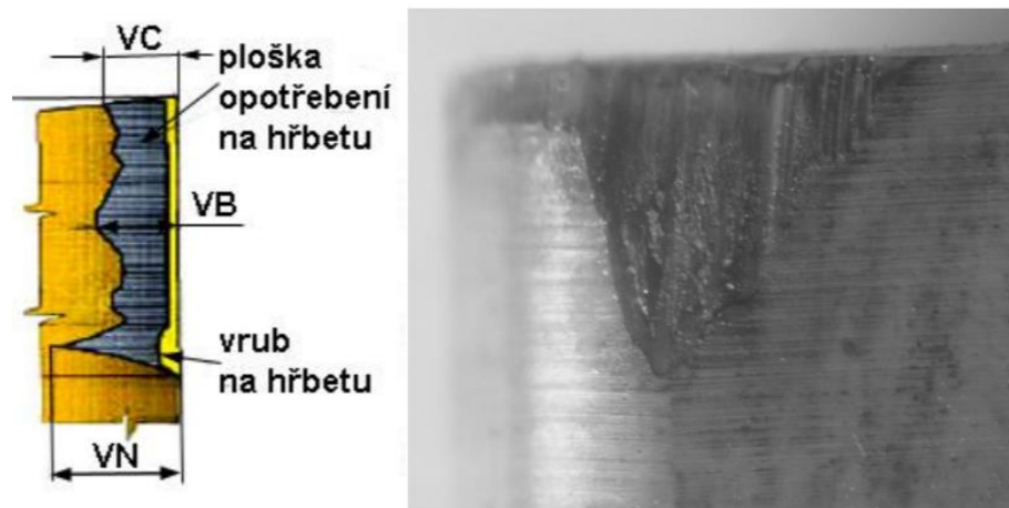
Obr. 20: Opotřebení na hřbetu nástroje [36] [37]
