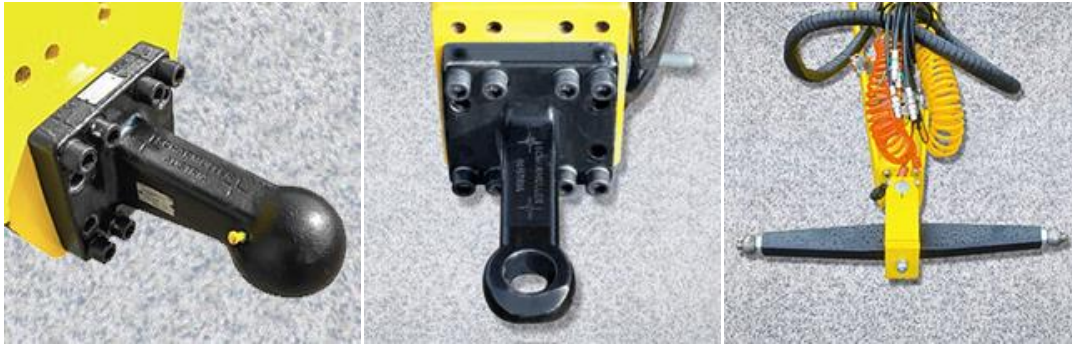
Obr. 25. Příklady tažných zařízení pro polonesené a nenesené stroje. [20]
