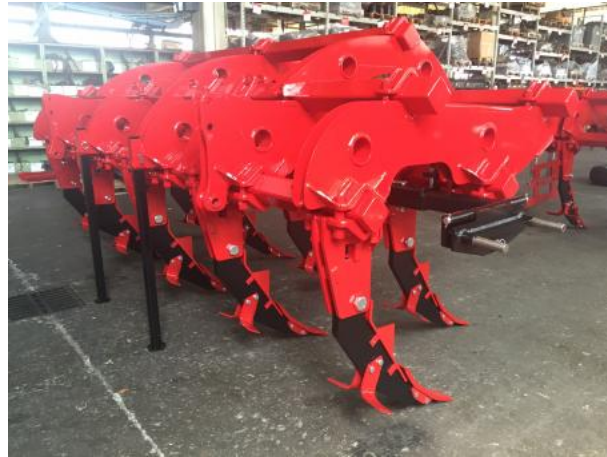
Obr. 11. Hlubkový dlátový kypříč nesené konstrukce Talon MAX (SMS CZ). [12]
