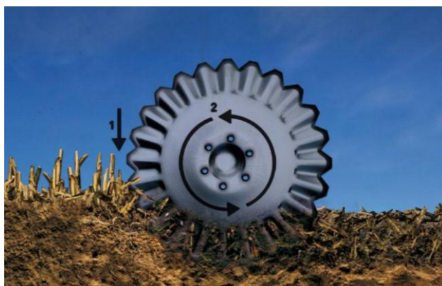
Obr. 9. Zapravování posklizňových zbytků diskovým orebním tělesem. [11]
