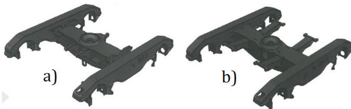
Obr. 6 Alternativní provedení rámu podvozku Y25 GBRS [17]
