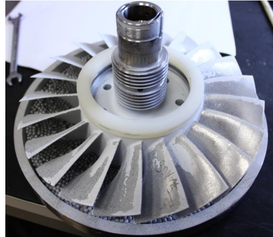
Obrázek 55: Kuličkování – distance 6 mm, čas 30 minut, přední strana, otočení o 180°
