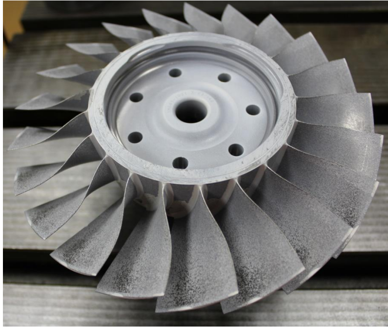
Obrázek 62: Kuličkování – 12mm distanční podložka, čas 60 minut z každé strany, rádius zadní strana
