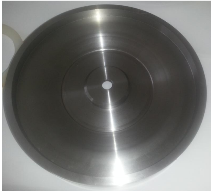
Obrázek 38: Obrobek – spodní díl přípravku
