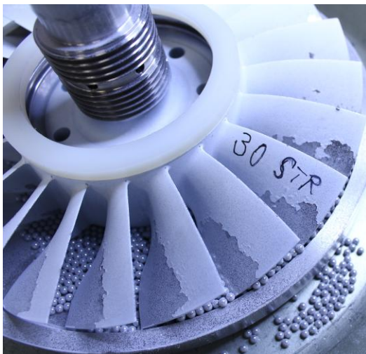
Obrázek 50: Kuličkování – distance 4 mm, čas 30 minut, přední strana
