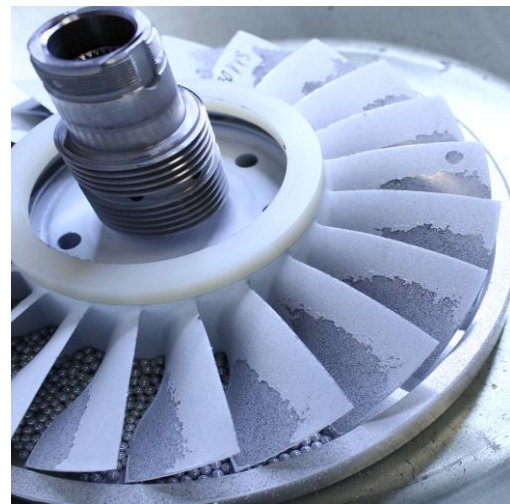
Obrázek 51: Kuličkování – distance 6 mm, čas 30 minut, přední strana
