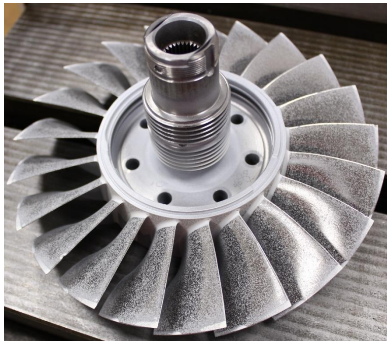
Obrázek 61: Kuličkování – 12mm distanční podložka, čas 60 minut z každé strany, rádius přední strana
