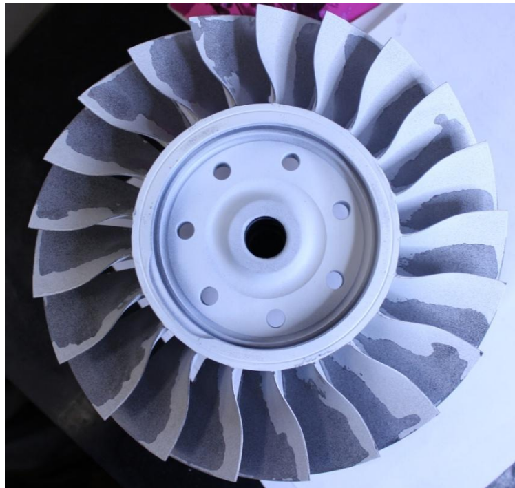
Obrázek 59: Kuličkování – 12mm distanční podložka, čas 60 minut z každé strany, zadní strana
