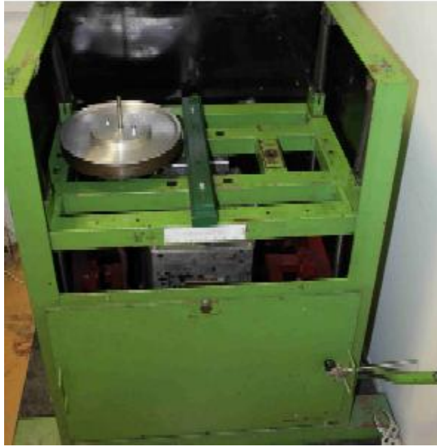
Obrázek 13: Vibrační rám se sezdola umístěným vibračním motorem
