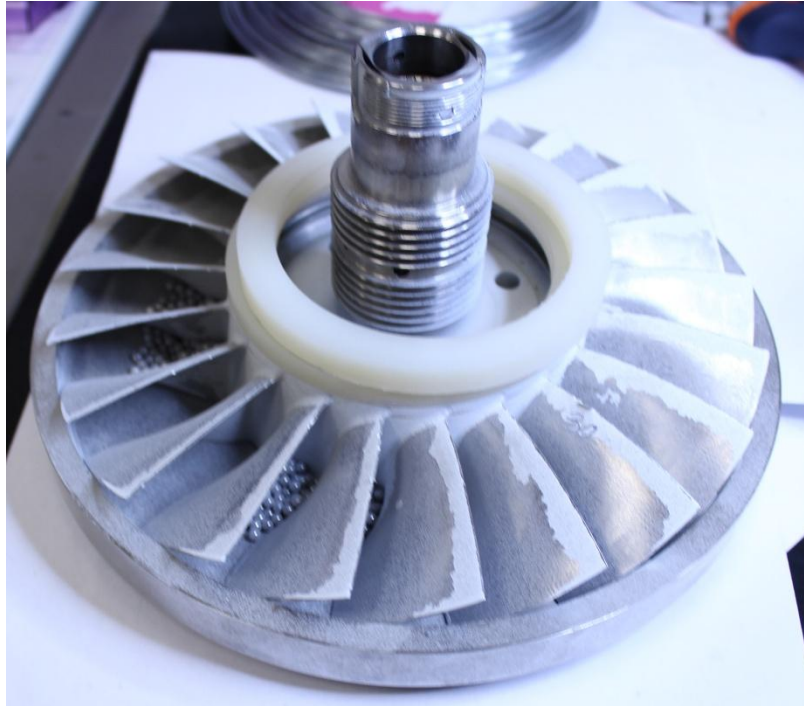
Obrázek 58: Kuličkování – 12mm distanční podložka, čas 60 minut z každé strany, přední strana
