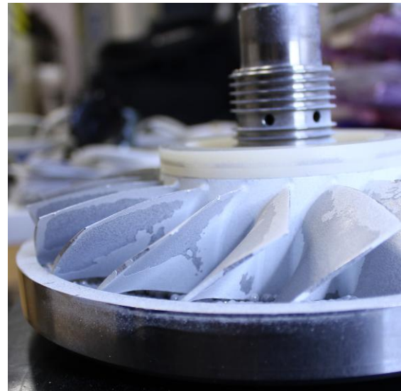
Obrázek 57: Kuličkování – distance 6 mm, čas 30 minut, zadní strana, otočení o 180°
