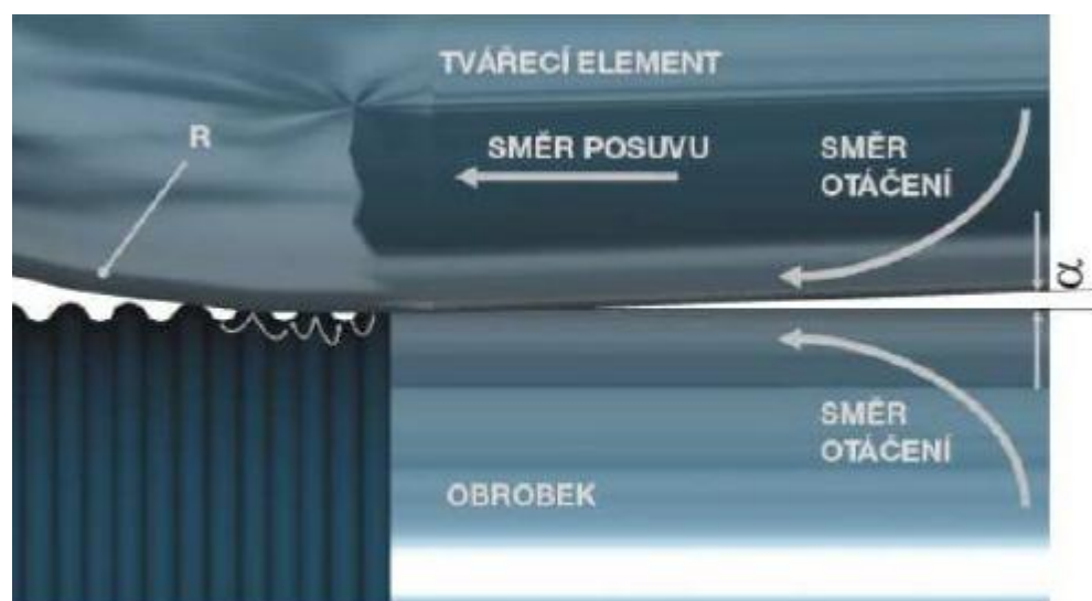
Obrázek 11: Schéma objemových a geometrických změn materiálu při válečkování [16]
