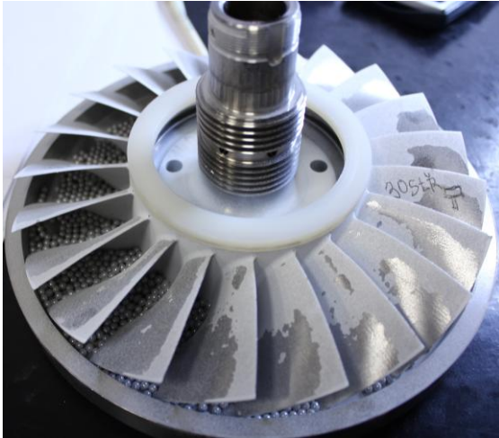
Obrázek 54: Kuličkování – distance 4 mm, čas 30 minut, přední strana, otočení o 180°
