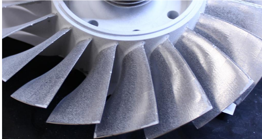
Obrázek 60: Kuličkování – 12mm distanční podložka, čas 60 minut z každé strany, rádius u paty lopatek
