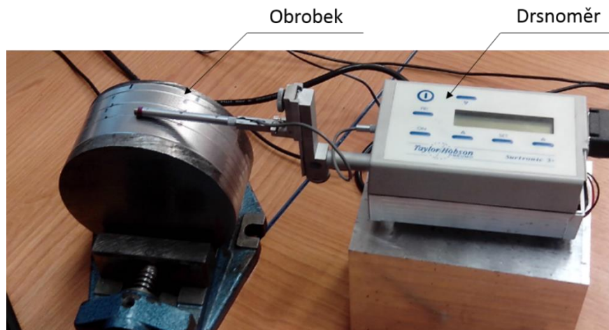
Obr. 73: Měření drsnosti na vzorku V3
