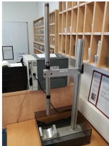
Obr. 42: Sestava zkoušky pádem kuličky
