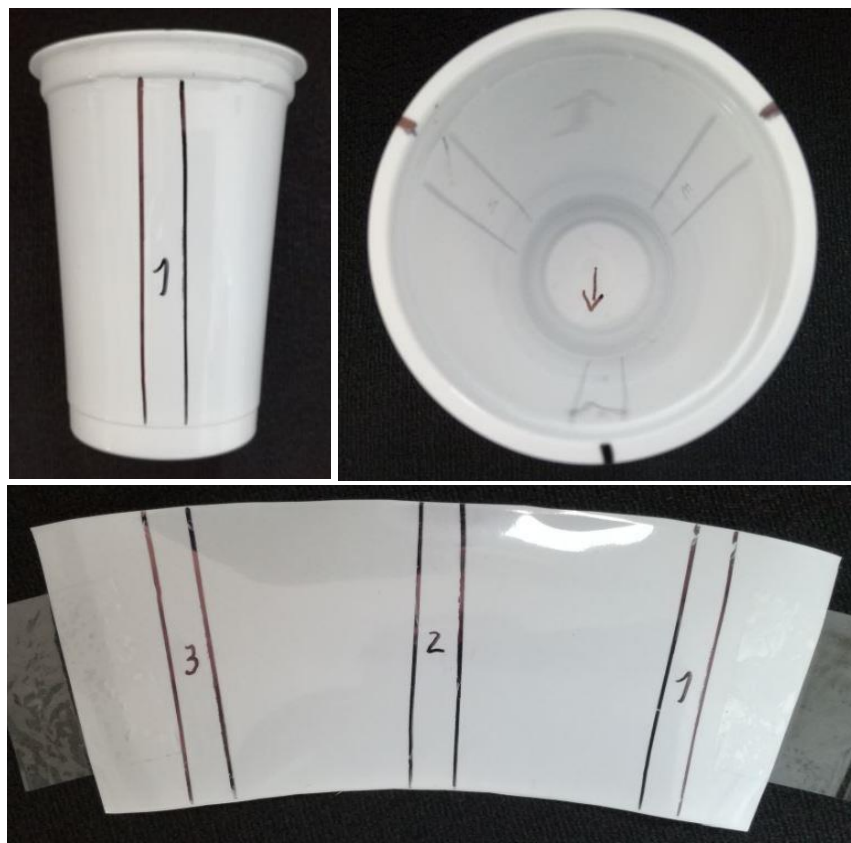
Obr. 35: Schéma odběru zkušebních těles
