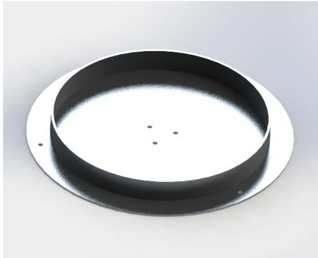
Obrázek 30 – Vyztužená konstrukce horní a spodní desky
