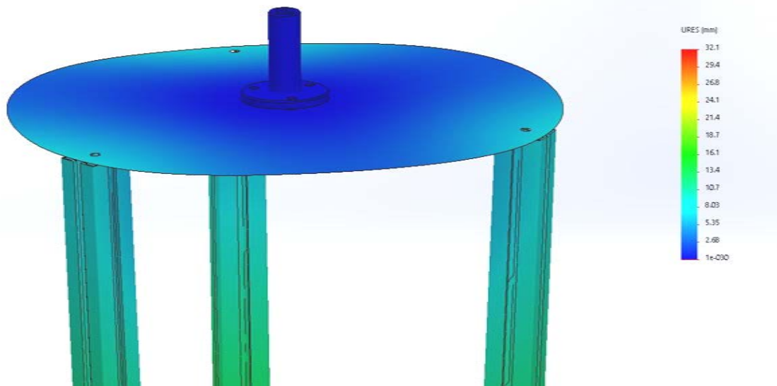
Obrázek 28 – Velikost deformací z MKP analýzy (bez výztuhy)
