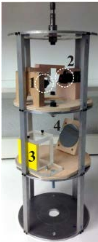
Obrázek 18 – Náhled na systémy platformy: (1) nezávislá CCD kamera, (2) Osvětlení, (3) Skloněné zrcadlo, (4) experiment [15]
