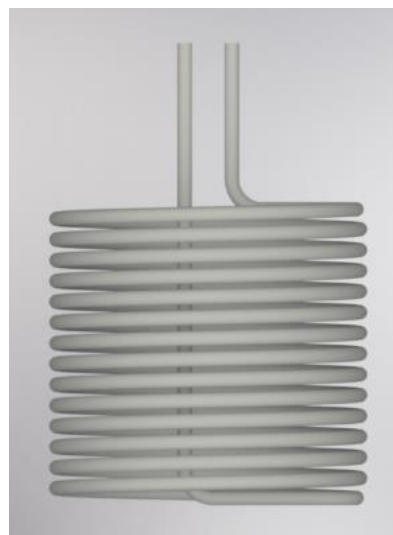
Obr. 4.3 – Instalace výměníku do jímky OV – možnost B
