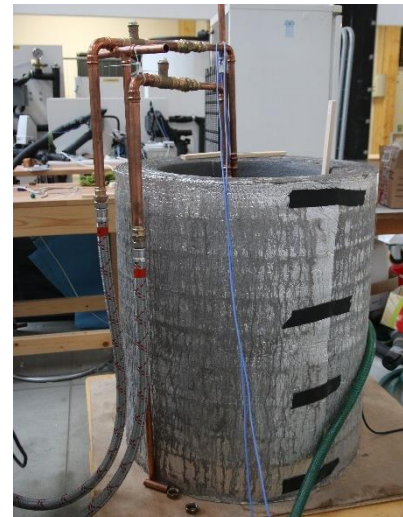
Obr. 5.2 – Jímka OV a umístění čidel Pt 100
