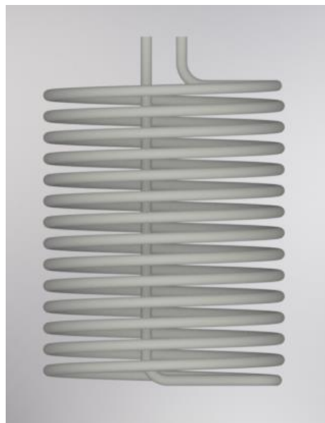
Obr. 4.4 – Instalace výměníku do jímky OV – možnost A
