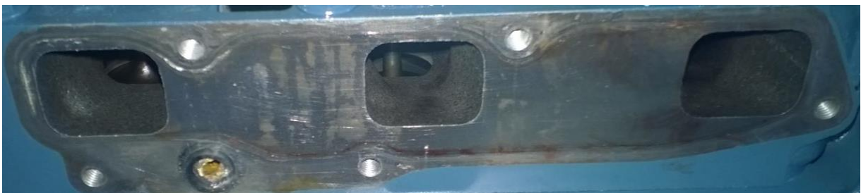
Obrázek 25 - Sací kanály v hlavě motoru s viditelným otiskem geometrie sacího nástavce
