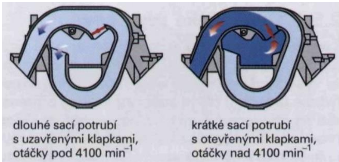
Obrázek 15 - Sací potrubí s proměnlivou délkou [3]
