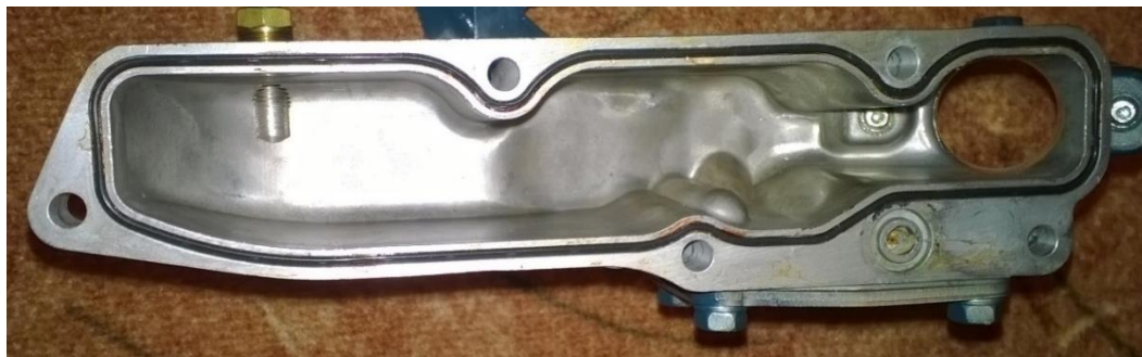
Obrázek 23 - Vnitřní geometrie sacího nástavce
