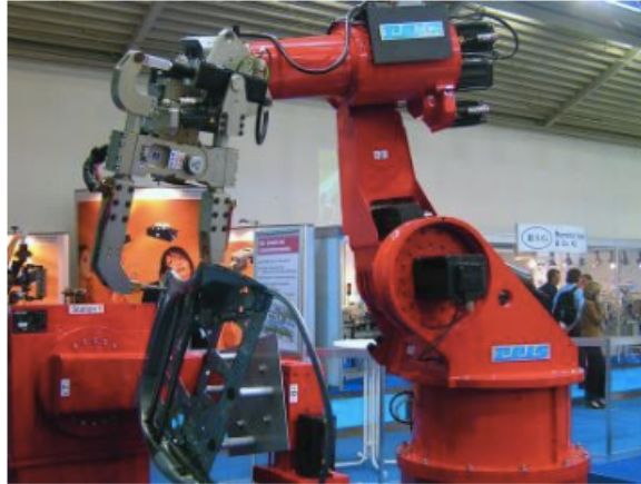
Obr. 3.4 - Robot s technologickou hlavicí pro bodové svařování [11]
