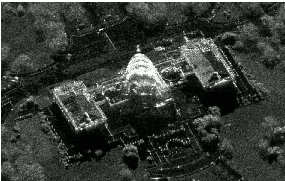
Obr.1 Digitální model budovy získaný pomocí radaru SAR
