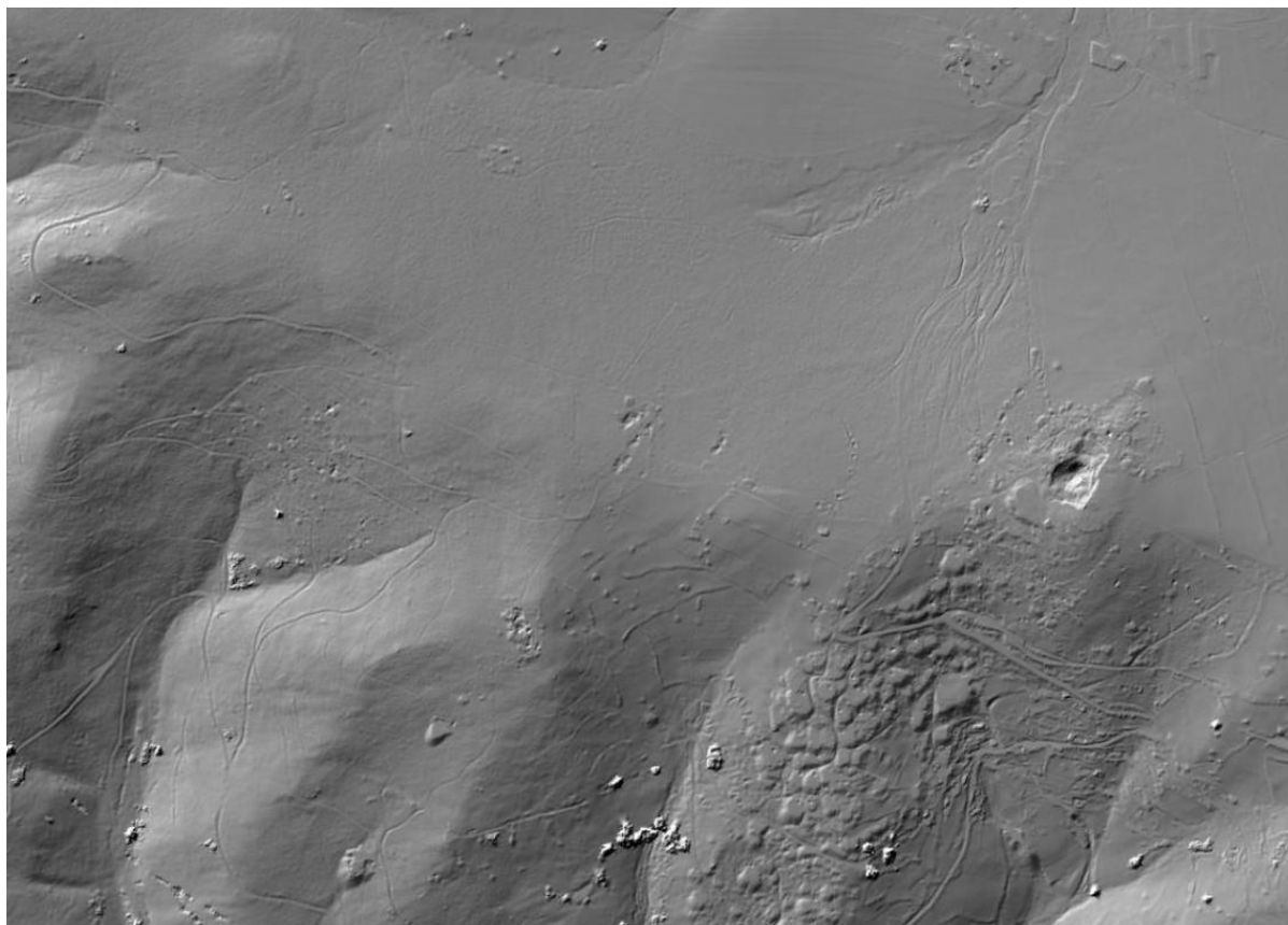
Obr. 18 Digitální model reliéfu získaný pomocí leteckého laserového skenování
