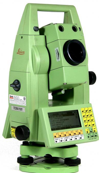
Obr.3 Totální stanice s laserovým skenerem Leica geosystem
