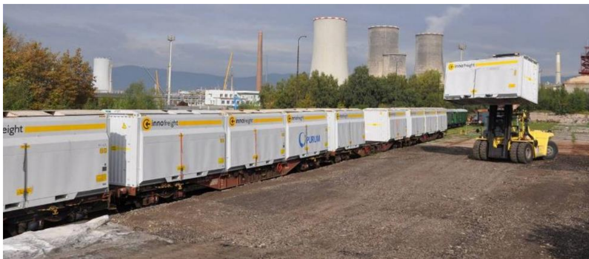
Obr. 17 Nakládka kontejnerů systému InnoFreight na vagony [23]
