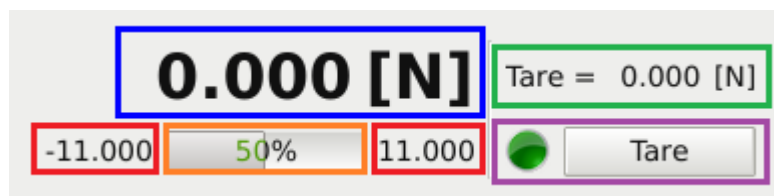
Obrázek č. 24: Ukázka pluginu pro zobrazení síly a tárování siloměru
