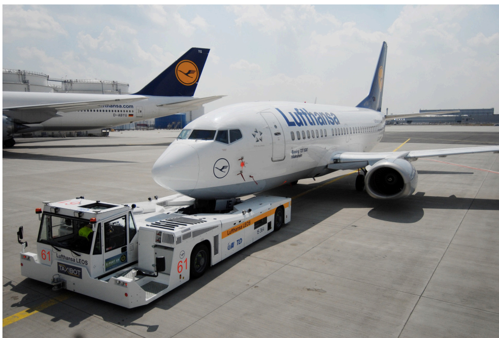
Obrázek 18: Taxibot a Boeing 737 společnosti Lufthansa na letišti ve Frankfurtu (zdroj: LH LEOS)
