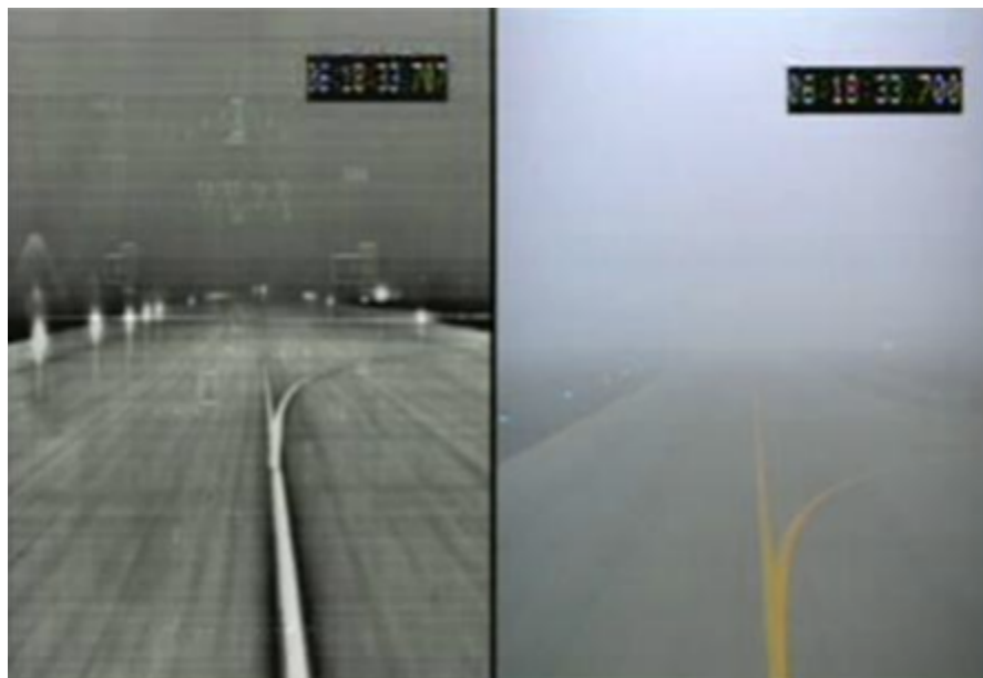
Obrázek 20, 21: Porovnání záběru EVS na letištní plochu (nalevo) se standatním pohledem (zdroj: faa.gov)
