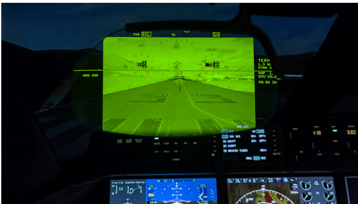
Obrázek 11: Enhanced Vision System instalovaný v letadle Gulfstream (zdroj: Gulfstream)
