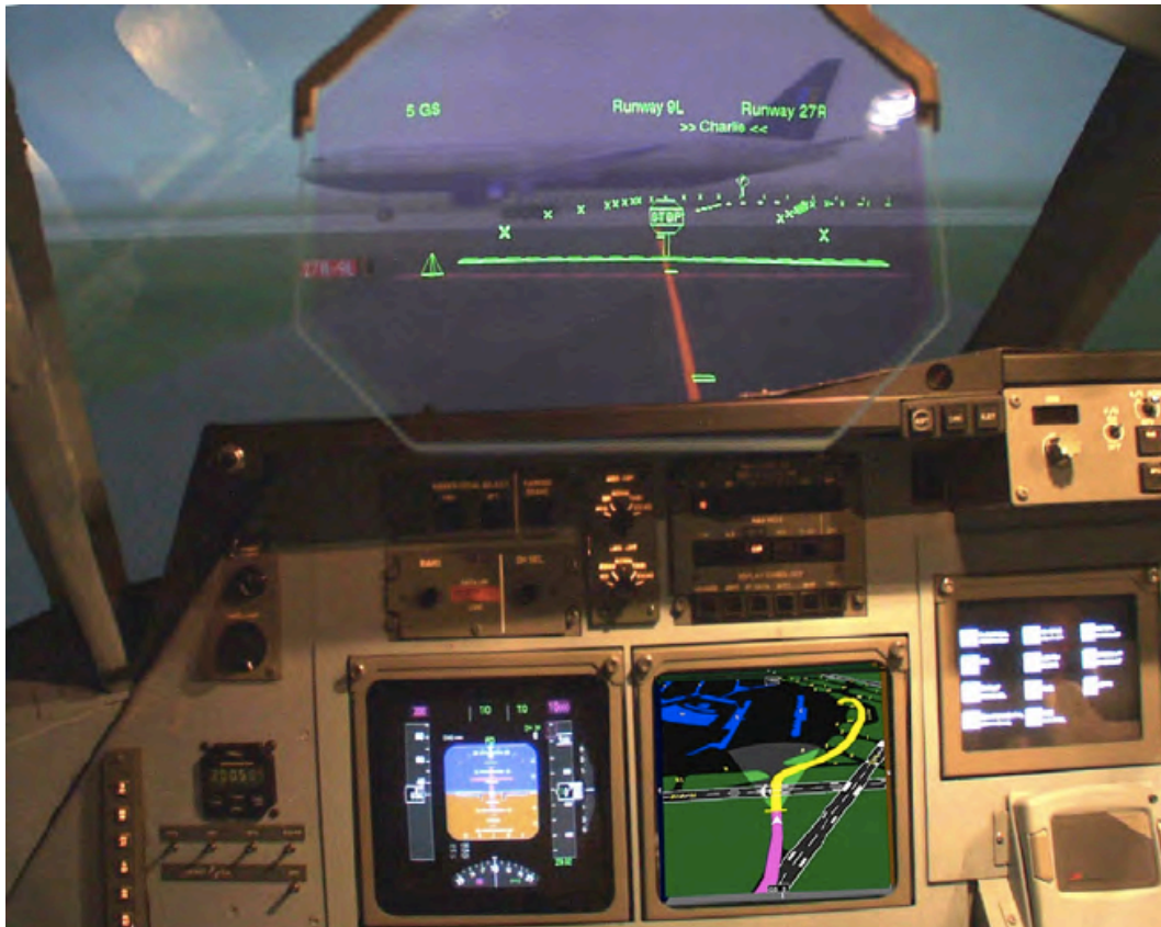
Obrázek 16: Celkový pohled z pohledu pilota při integraci HUD a EMM (zdroj: NASA Ames Research Center)
