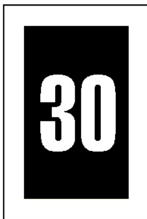
Obr. 29: Možná podoba návěsti, která by umožňovala vyšší rychlost jízdy přes kolejovou konstrukci vycházející z návěsti pro nejvyšší dovolenou rychlost z předpisu D 1/2. (Zdroj původního obr.: [5])
