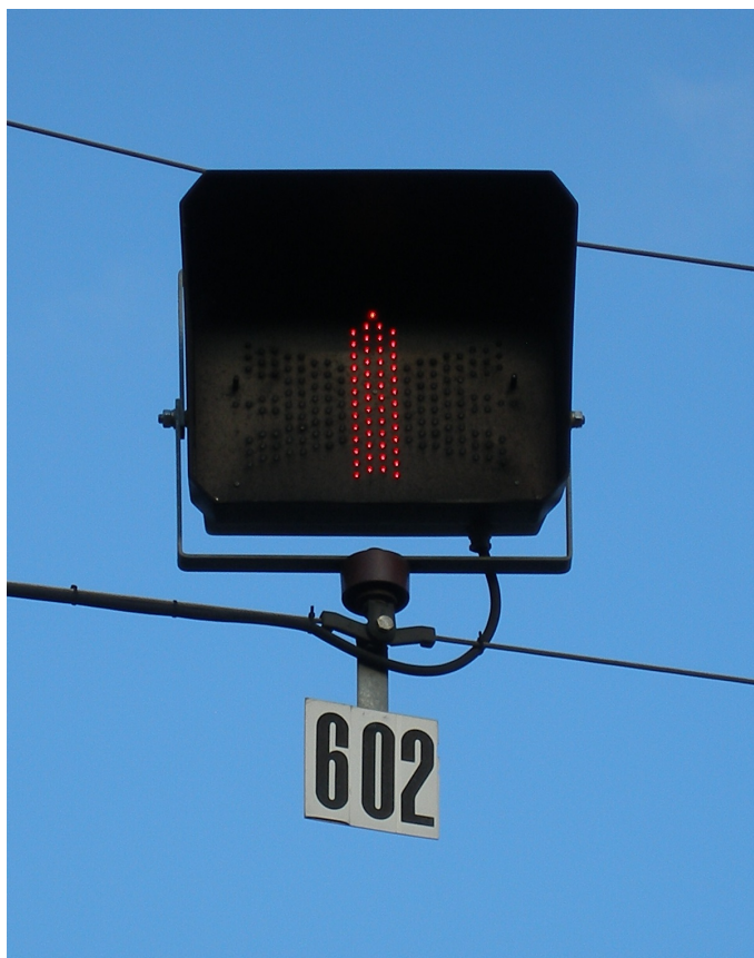
Obr. 14: Dnes používané diodové výhybkové návěstidlo v Hlubočepích (12/2008, archiv J. Hradila).
